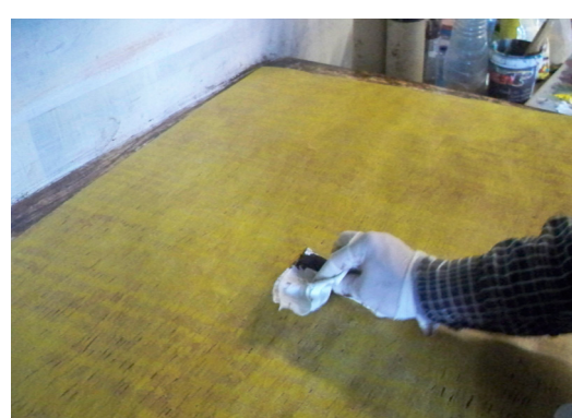
Fig. 39 Cuando la capa de nogalina está bien seca, se procede al bruñido frotando con un trapo de algodón.
