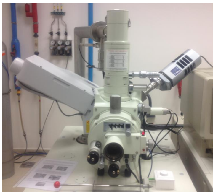
Figura 5.4. Microscopio electrónico de barrido JSM modelo 63
