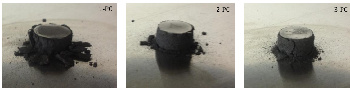
Figura 6.19. Imágenes de muestras 1-PC, 2-PC, 3-PC ensayadas a compresión.
