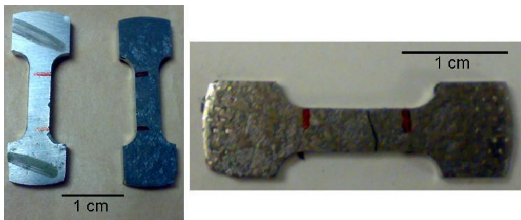
Figura 5.27 Probetas de tracción, A) antes del ensayo y B) muestra 3 después del ensayo.
