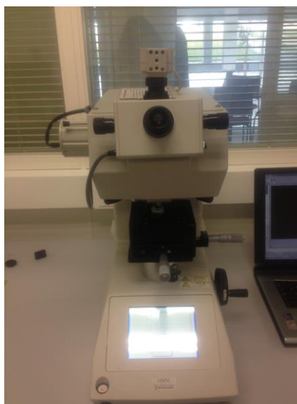
Imagen 5.13. Microdurómetro SHIMADZU HMV.
