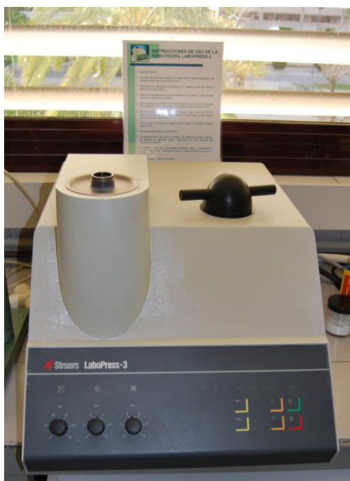
Figura 5.6. Embutidora Struers LaboPress – 3
