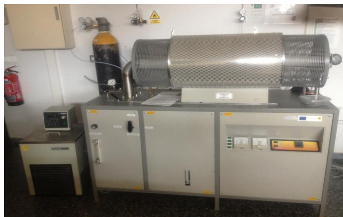
Figura 5.16. Horno Carbolite modelo HVT 15/75/450
