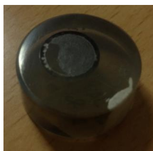
Figura 5.7 Polvo de 30 \mu\text{m} embutido en resina
