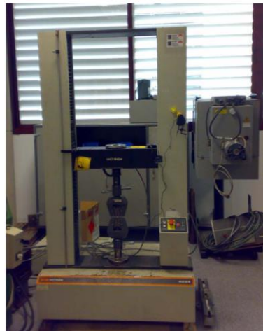
Figura 5.20 Máquina Universal de Ensayos estáticos de 50kN INSTRON modelo 4204 (ITM).
