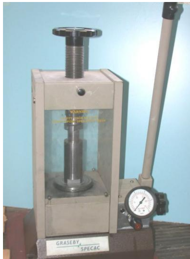
Figura 5.14. Prensa manual de acción simple (uniaxial).
