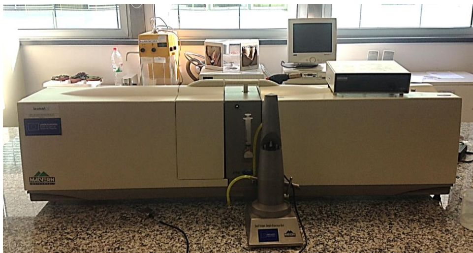
Figura 5.1. Analizador de tamaño de partícula Mastersizer 2000. Delante el accesorio Hydro 2000SM
