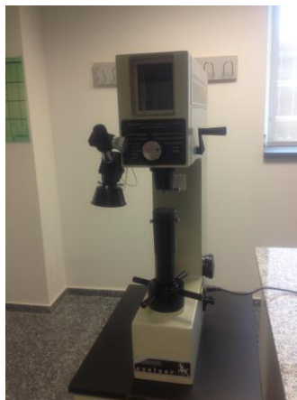
Figura 5.24. Durómetro marca Centaur modelo HBRVU-187.5 Brinell Rockwell and Vickers Optical Harness Tester.
