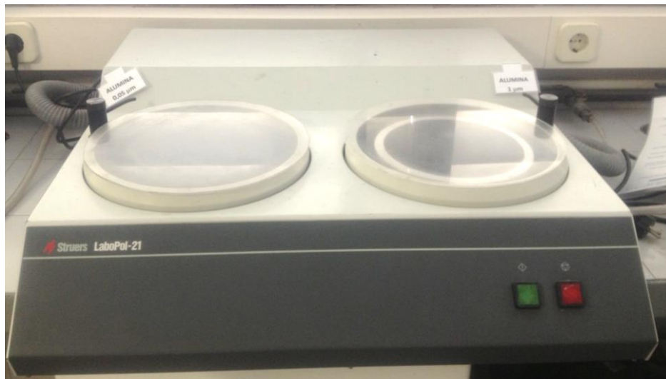
Figura 5.8. Equipo de desbaste Struers LaboPol-21
