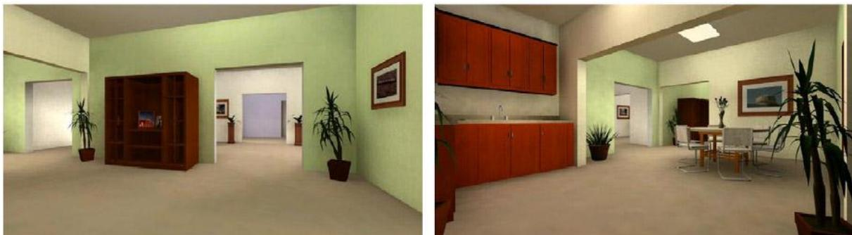
Fig 5. Visualización interactiva navegable en tiempo real de un modelo BIM creado con Revit desarrollada por el equipo de Wei Yan utilizando tecnología de creación de videojuegos. 2011
