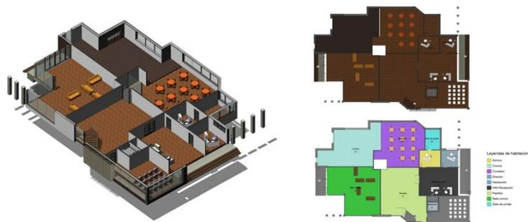
Figura 2: Planta Baja distribución, zonificación y representación 3d. Fuente: Elaboración propia
