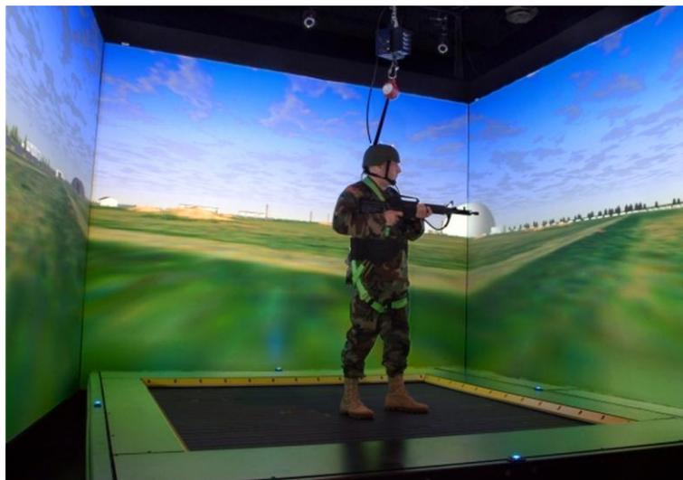
Fig 2. Navegación mediante cinta andadora multidireccional en un entorno virtual CAVE en el Army Research Laboratory. 2007.
