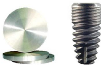
Figura 21. Imágenes ampliadas de los discos de titanio (izquierda) empleados para la evaluación in vitro de los recubrimientos y de los implantes de titanio (derecha) utilizados en las fases de experimentación in vivo , todos ellos suministrados por Ilerimplant S.L.
