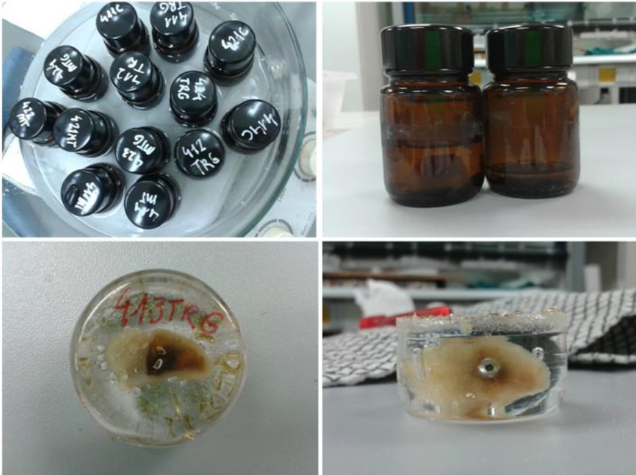
Figura 36. Proceso de inclusión de muestras óseas sin descalcificar en metil-metacrilato (MMA); polimerización a baño maría con codificación resistente al agua (arriba izquierda), viales con muestra polimerizada y con lecho polimerizado (arriba derecha), visión frontal de una sección transversal de tibia de conejo con implante dental polimerizada y correctamente codificada (abajo izquierda) y visión lateral de una muestra donde se puede observar la parte superior de la prótesis radicular implantada en tibia de conejo (abajo derecha).
