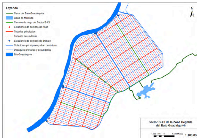
Figura 1. Embalse de Melendo y sistemas de riego y de drenaje del Sector B-XII
