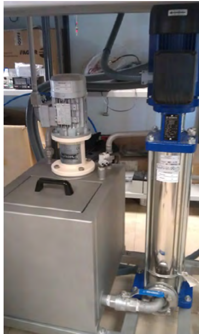
Figura 3 – Agitador de partículas y bomba centrífuga
