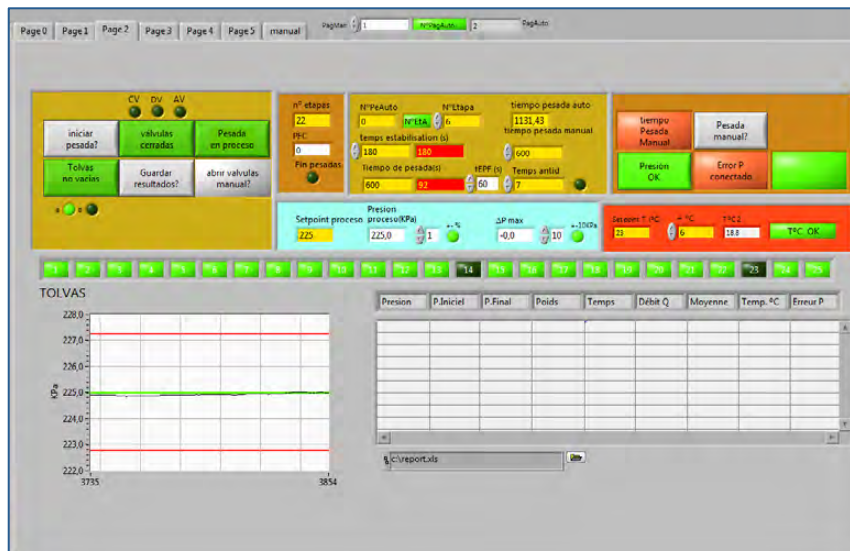
Figura 4: Pantalla de control de la etapa de ensayo. Estado de la pesada y verificación de la presión consigna con límites de alarma.
