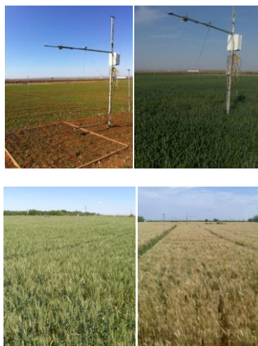
Figura 1. Montaje experimental sobre el lisímetro para los días julianos 55 y 129 (superior), y panorámica de la condiciones de la plantación del trigo para los días 153 y 174 (inferior).
