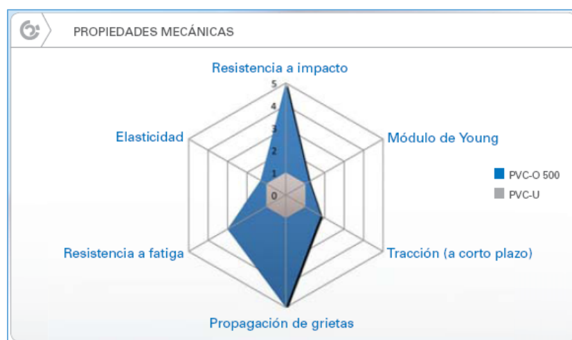
Figura 8 Comparativa propiedades mecánicas del PVC-o vs al PVC-U
