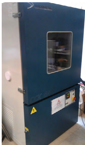
Figura 6 – Cámara climática empleada para conseguir la temperatura objetivo
