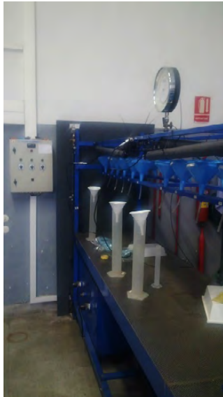
Imagen.1. Banco de ensayos para obtener la curva de gasto.
