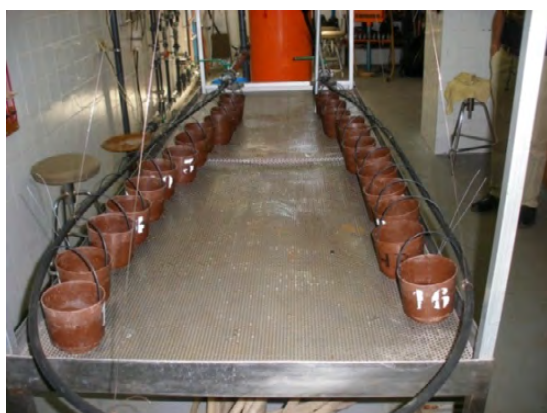
Foto 2. Ensayo para la determinación del Coeficiente de Variación de caudal de los microtubos.
