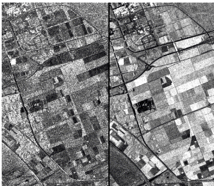
Figura 3.- Reducción del ruido ( speckle ) mediante promediado de sucesivas imágenes.
