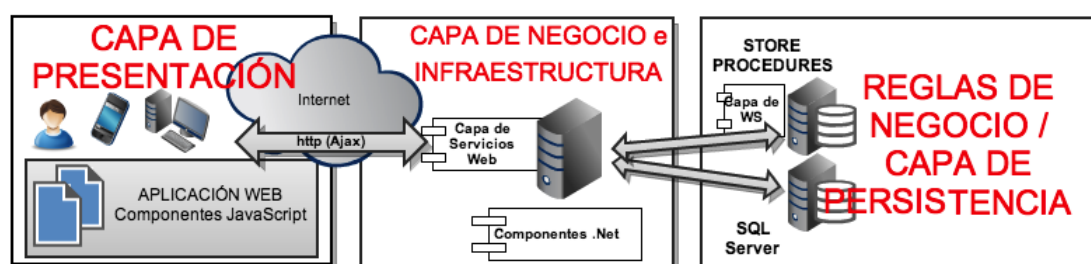
Figura 1.1: ejemplo de arquitectura distribuida basada en capas
