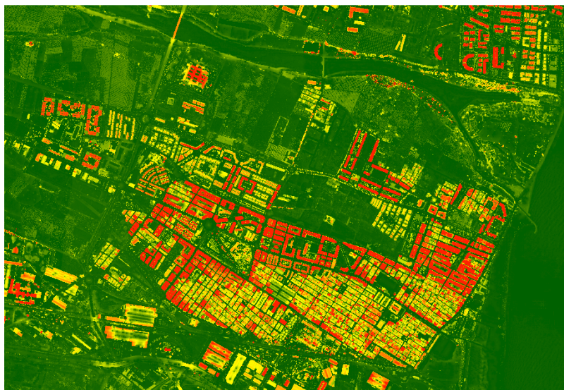
Figura 5.5. Modelo normalizado con las alturas de los objetos de la zona de Puerto de Sagunto y Canet d'en Berenguer
