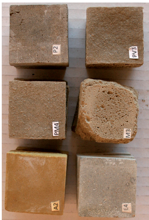
Fig. 3. Fotografía de las muestras después de haber sido sometidas a el ensayo de envejecimiento artificial acelerado en atmósfera saturada de \text{SO}_2
