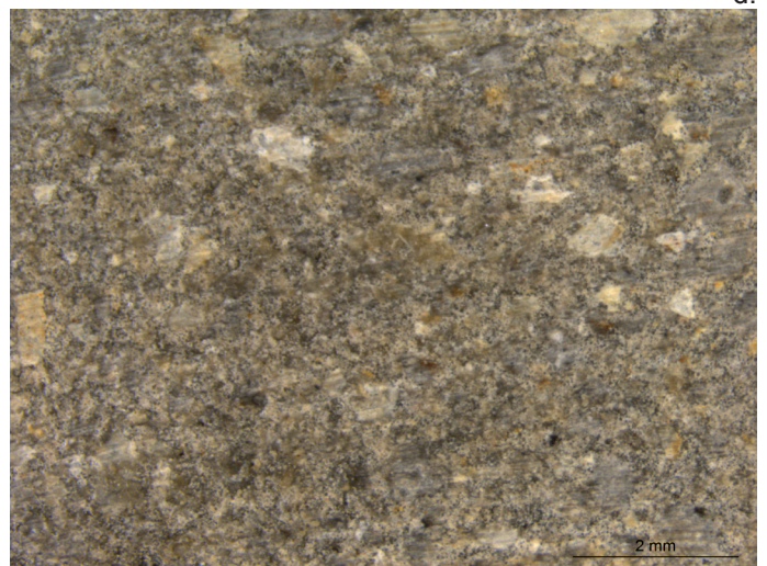
Fotografías antes (a, c, e) y después (b, d, f) de ensayo de envejecimiento artificial acelerado en atmósfera saturada de SO 2 en masilla PARALOID B72®+ matriz de fósil pulverizada + microesferas de vidrio x8 aumentos.
