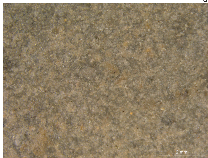
Fotografías antes (a, c, e) y después (b, d, f) de ensayo de envejecimiento artificial acelerado en atmósfera saturada de SO 2 en masilla PVA + matriz de fósil pulverizada + microesferas de vidrio x8 aumentos.
