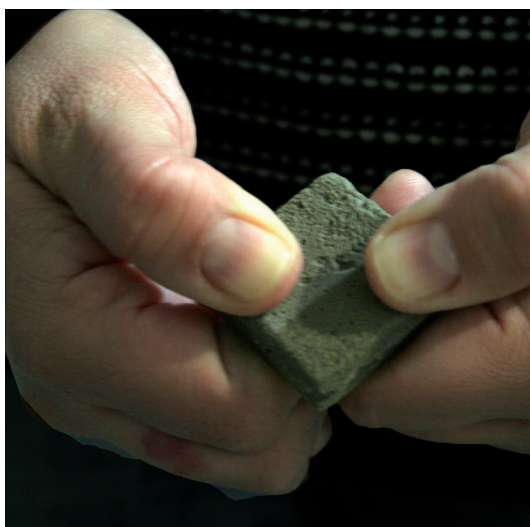
Fig. 14. Fotografía de las pruebas de resistencia estructural a la aplicación de fuerza manual.
