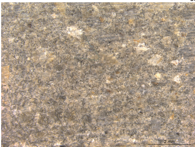
Fotografías antes (a, c, e) y después (b, d, f) de ensayo de envejecimiento artificial acelerado en atmósfera saturada de SO 2 en masilla PARALOID B72®+ matriz de fósil pulverizada + microesferas de vidrio x8 aumentos.
