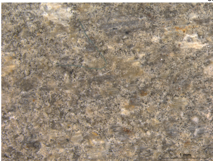
Fotografías antes (a, c, e) y después (b, d, f) de ensayo de envejecimiento artificial acelerado en atmósfera saturada de SO 2 en masilla PARALOID B72®+ matriz de fósil pulverizada + microesferas de vidrio x16 aumentos.
