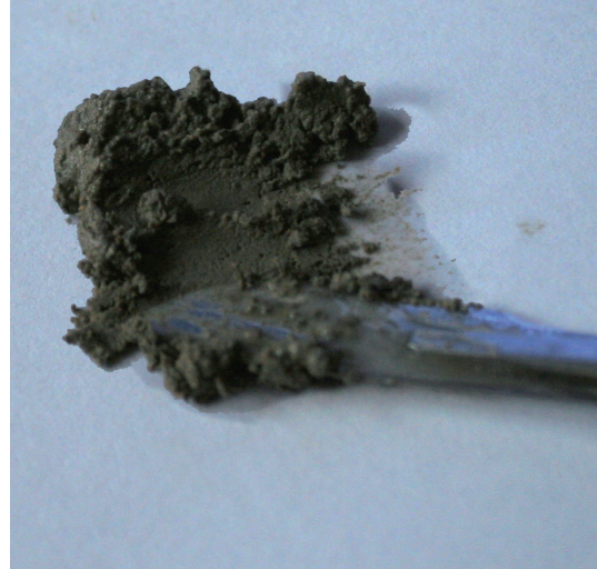
Fig. 14. Fotografía de preparación de la masilla a base de Mowital B60HH®.
