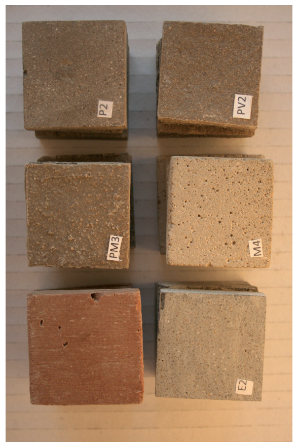
Fig. 4. Fotografía de las muestras después de haber sido sometidas a el ensayo de envejecimiento artificial acelerado de humedad y temperatura
