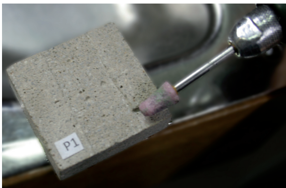
Fig. 7. Fotografía de pruebas de lijado y pulido mediante micromotor.
