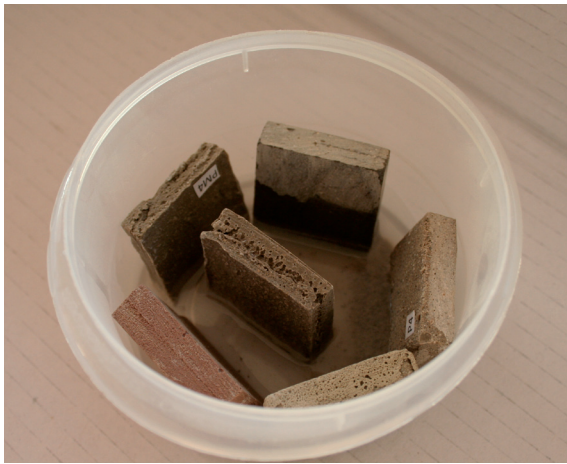
Fig. 5. Fotografía de las muestras durante el ensayo de reversibilidad tras 30 minutos en acetona.
