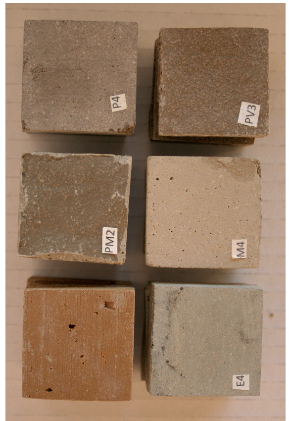
Fig. 2. Fotografía de las muestras después de haber sido sometidas a el ensayo de envejecimiento artificial acelerado por irradiación UV.
