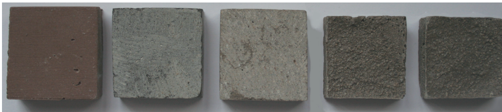
Fig. 8. Fotografía en la que se evidencia la pérdida de volumen en las masillas a base de PVA
