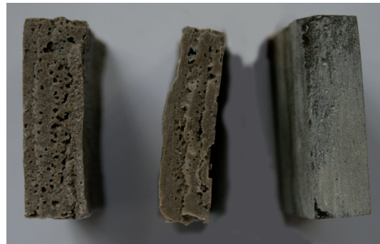
Fig. 15. Fotografía de detalle de el secado por estratificación en las masillas de PVA.
