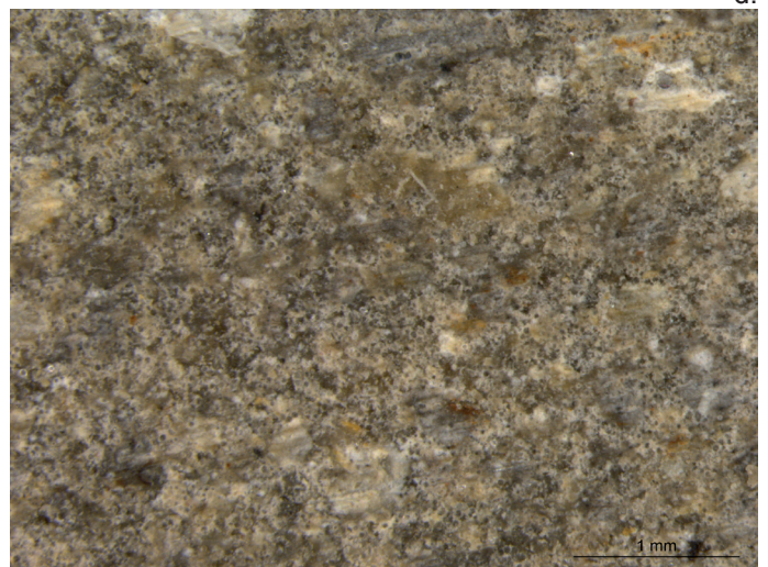
Fotografías antes (a, c, e) y después (b, d, f) de ensayo de envejecimiento artificial acelerado en atmósfera saturada de SO 2 en masilla PARALOID B72®+ matriz de fósil pulverizada + microesferas de vidrio x16 aumentos.
