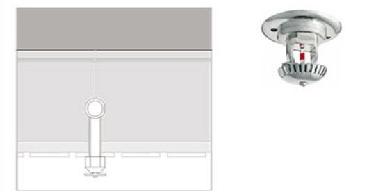
3. Sprinkler (rociador y detector de incendios)
