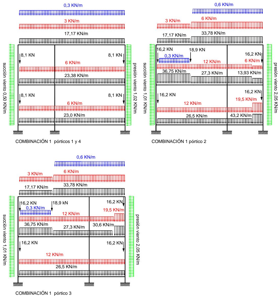
Figura 2. Combinación de Hipótesis 1 ELU: Acción variable fundamental la sobrecarga de uso.
