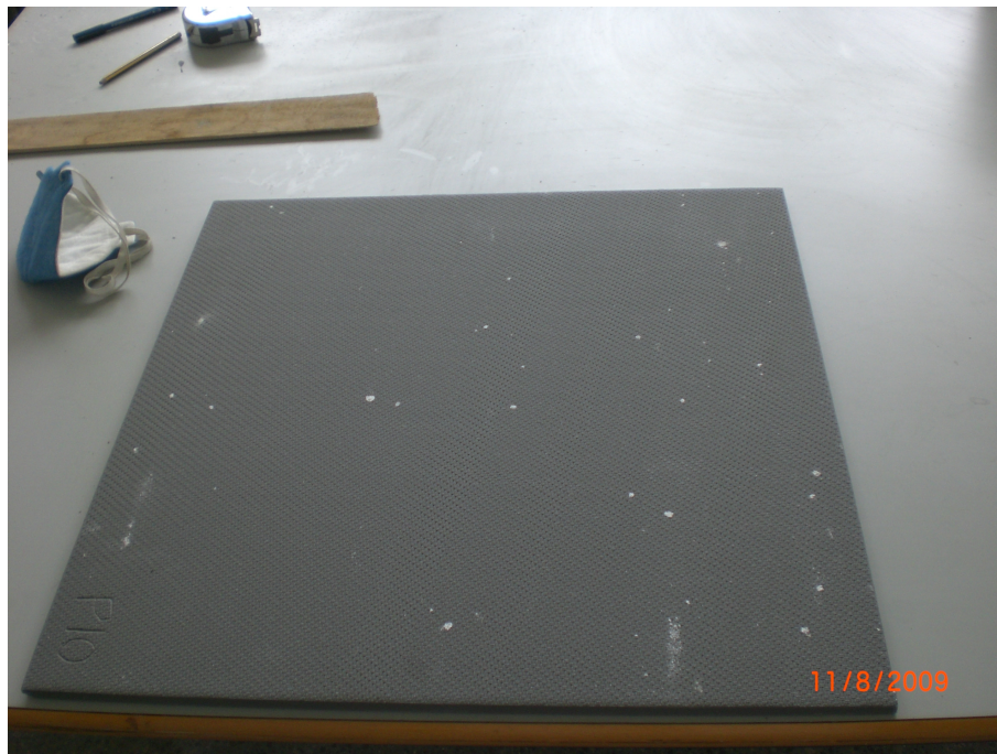
Fotografía n° 10: Aspecto de una de las baldosas (probeta n° 10), lista para ser mecanizada
