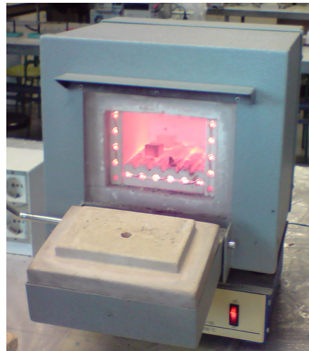
Figura 14.- Horno de laboratorio, temperatura de proceso de hasta 1300°C.
