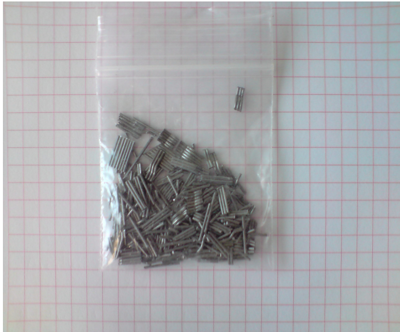
Fotografía nº 6: muestra de las fibras metálicas (dramix©)empleadas como refuerzos
