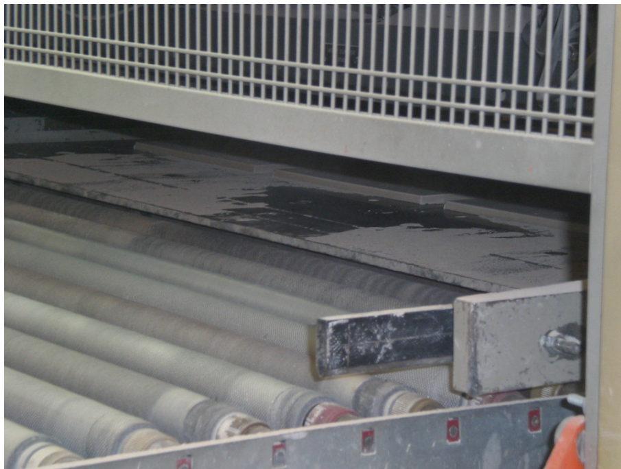
Fotografía n° 2: proceso de prensado de las baldosas de gres porcelánico
