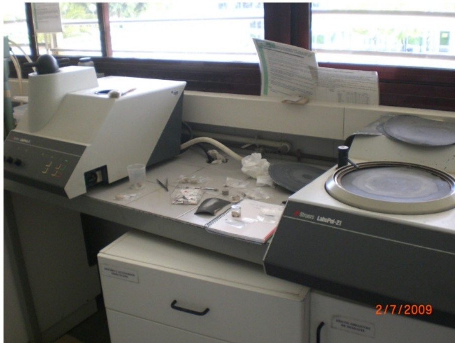
Fotografía n° 8: Preparación de la embutición de las muestras previamente a su preparación.
