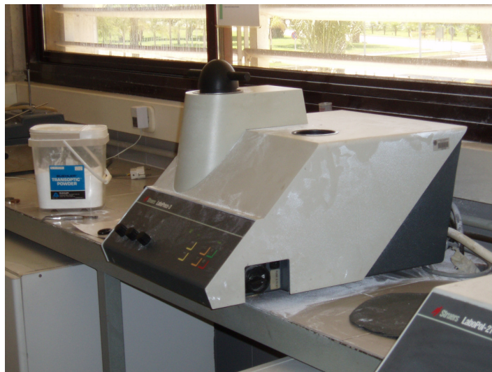
Fotografía n° 13: Embutidora Struers Labopress 3, donde se embutieron las probetas
