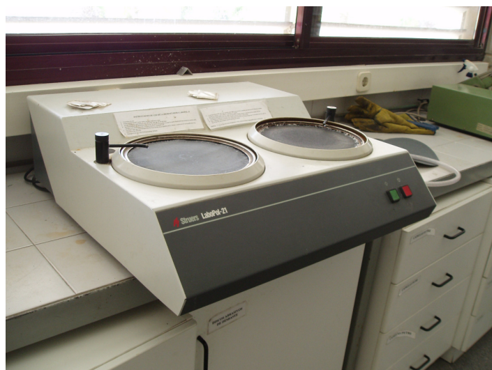
Fotografía n° 14: Se procedió a un desbastado con lija de 250 y pulido con lijas de 500 y 1000.
