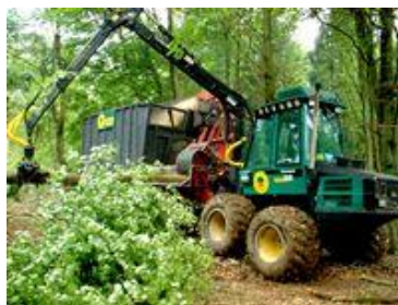
Figura 16. Astilladora Erjo 765 acoplada a autocargador Timberjack 1210. Fuente: http://www.pracbrown.co.uk
