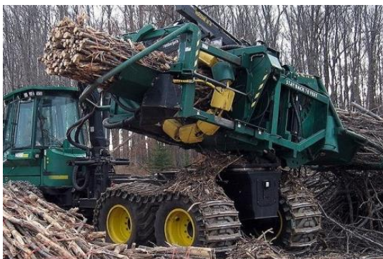
Figura 18. Empacadora de residuos forestales Timberjack. Fuente: http://michigansaf.org/
