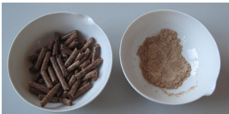
Figura 76. Muestra y molienda de la muestra sobre crisol de ensayo.
