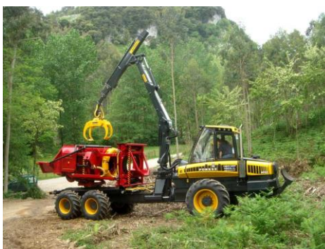
Figura 17. Empacadora de residuos forestales ENFO 2000 sobre autocargador PONSEE. Fuente: http://www.monraforestal.com/
