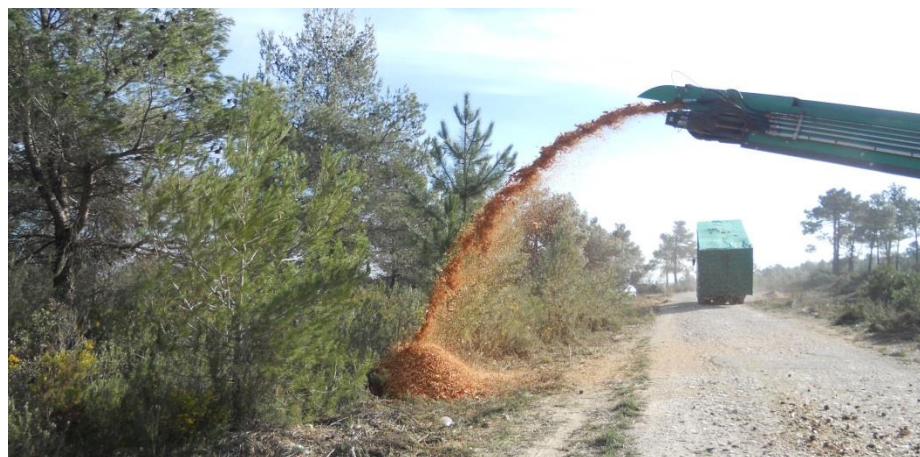
Figura 49. Astillado en cargadero.
