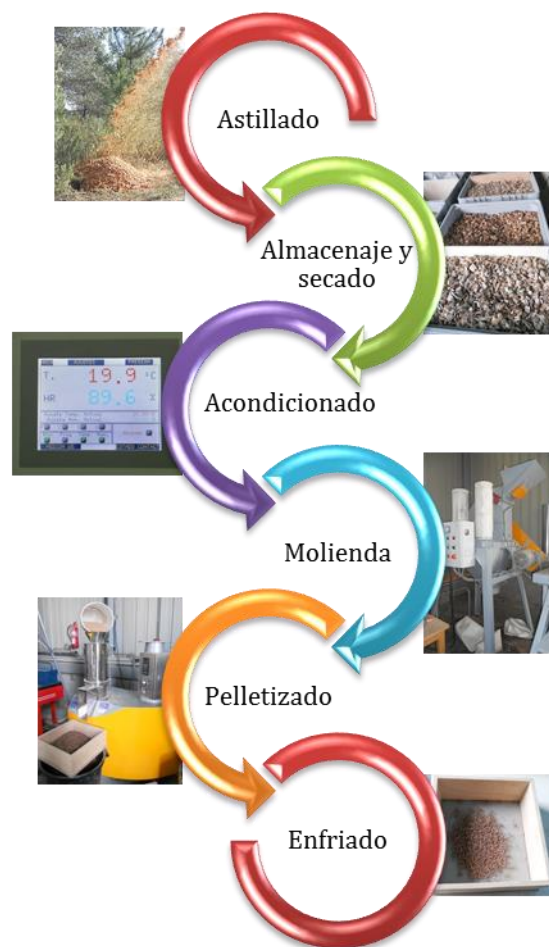
Figura 61. Fases de producción de los pellets. Fuente: elaboración propia.
