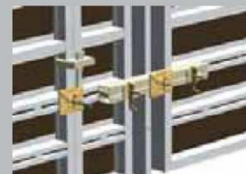
Detalle de montaje de panel de compensación y mordazas de cierre.
