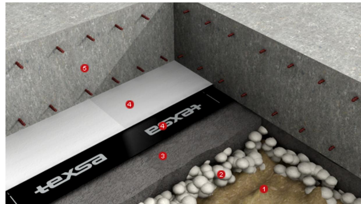
Para el sellado de la losa con los muros de pantalla y en las juntas de hormigonado se colocará un cordón sellante de bentonita de sodio natural.
