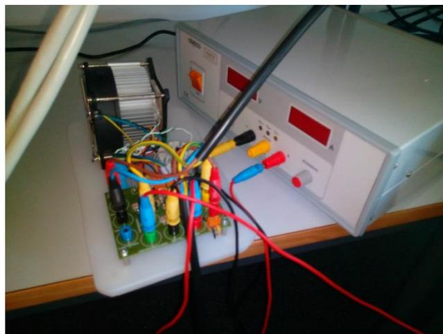
Figura 3. Montaje de la Célula Peltier en laboratorio
