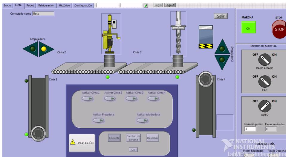
Figura 2. Pestaña de "Cintas" de la pantalla diseñada para monitorizar el proceso
