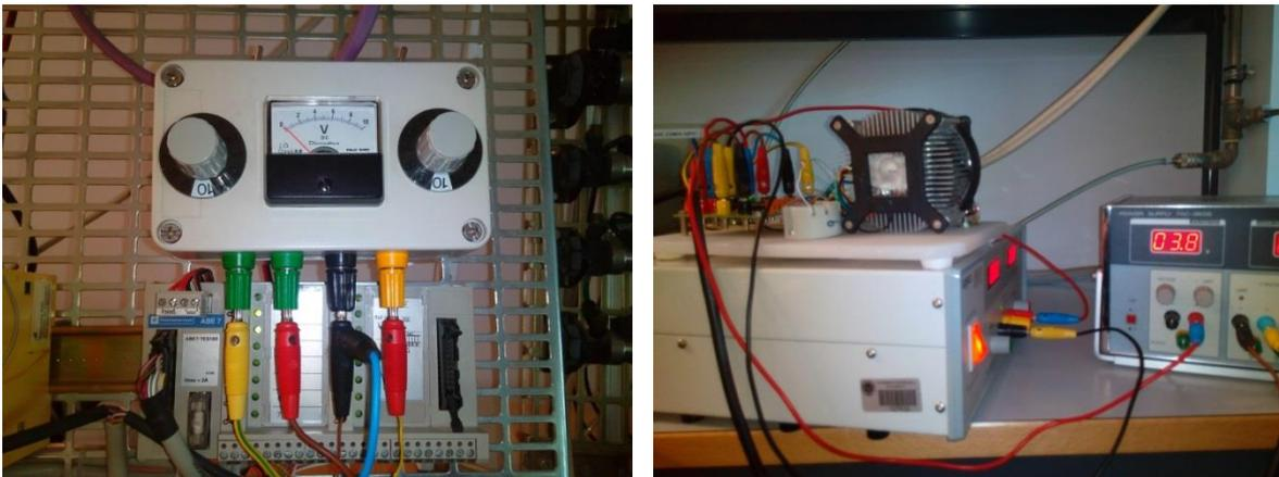
*Figura 2. Imágenes del montaje de la Peltier en laboratorio*
