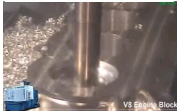
*Figura 7. Fresadora con cabezal grande practicando el agujero de los cilindros*
