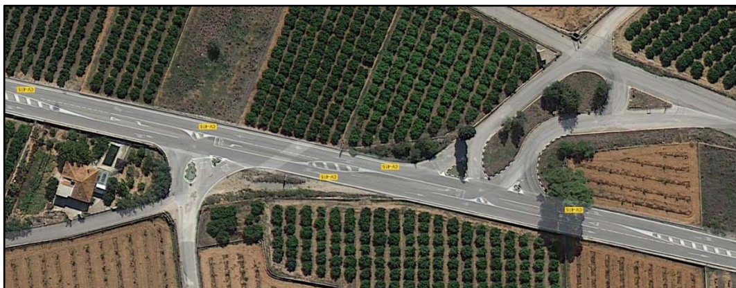
Intersección Canalizada en desfase ( Fuente: Google Maps)
