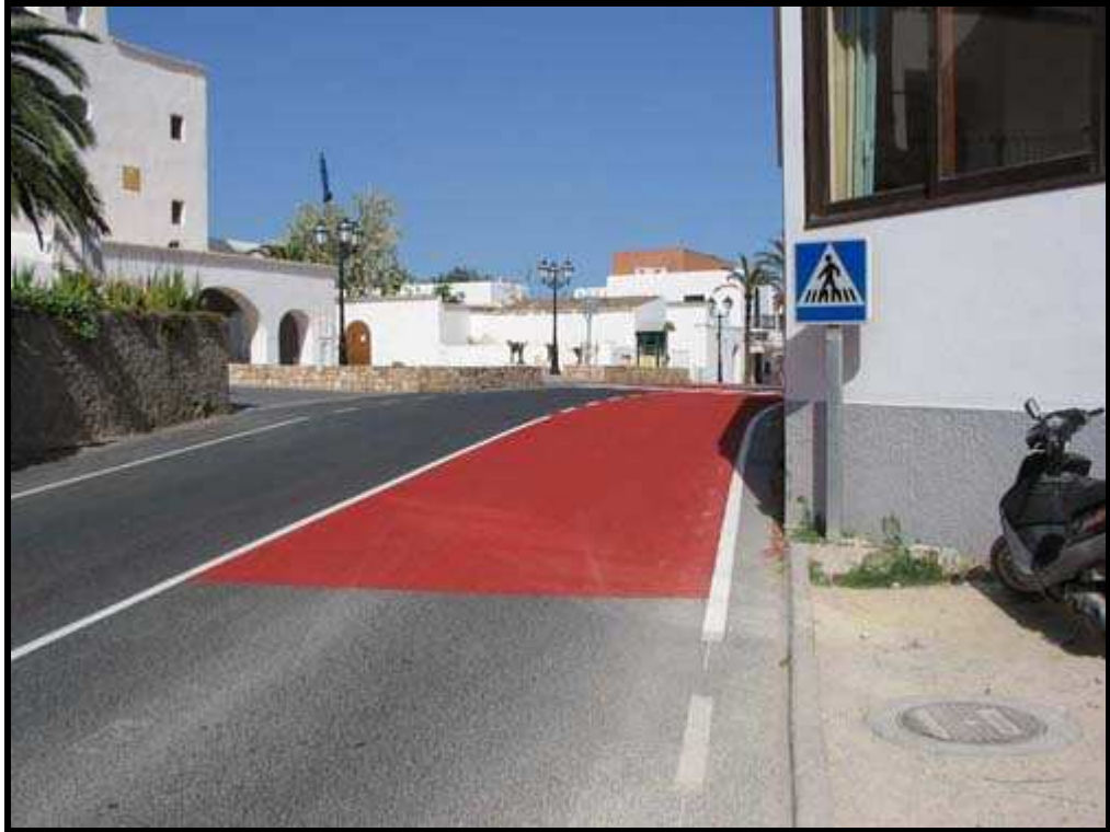
Ilustración 117 Pavimento de alta fricción en una travesía Sant Josep, Ibiza
