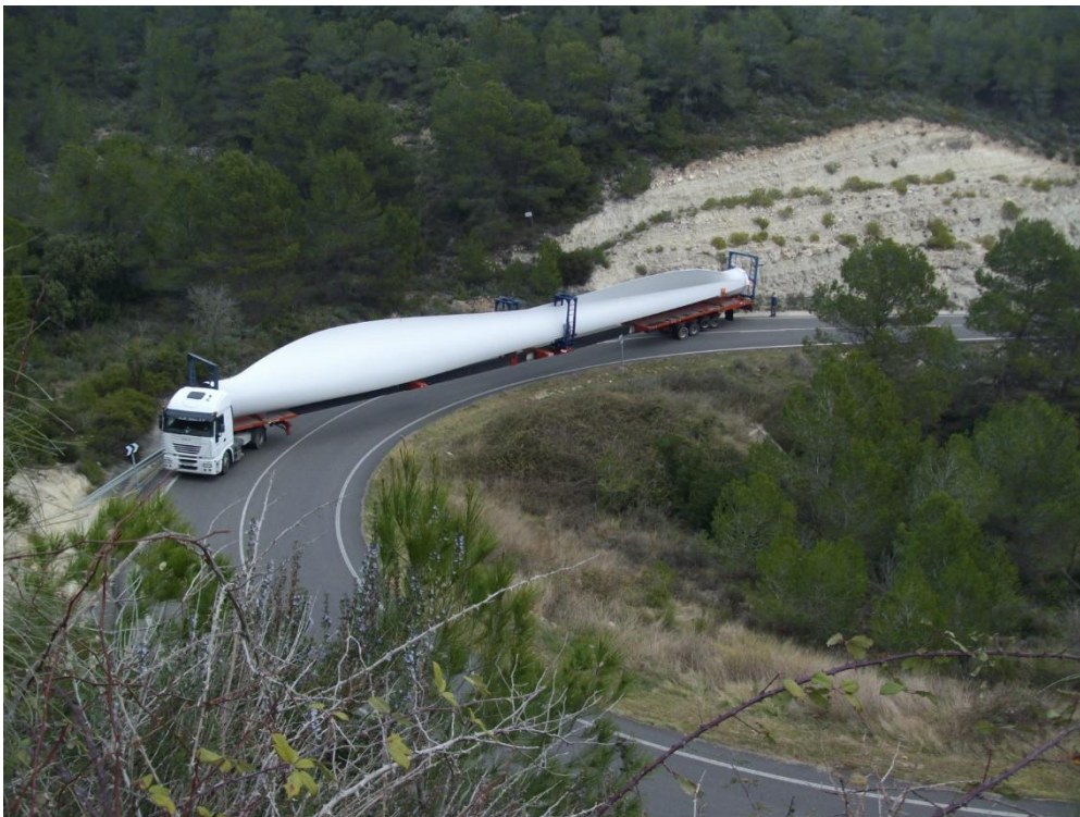
Figura 6. Transporte de una pala de rotor
