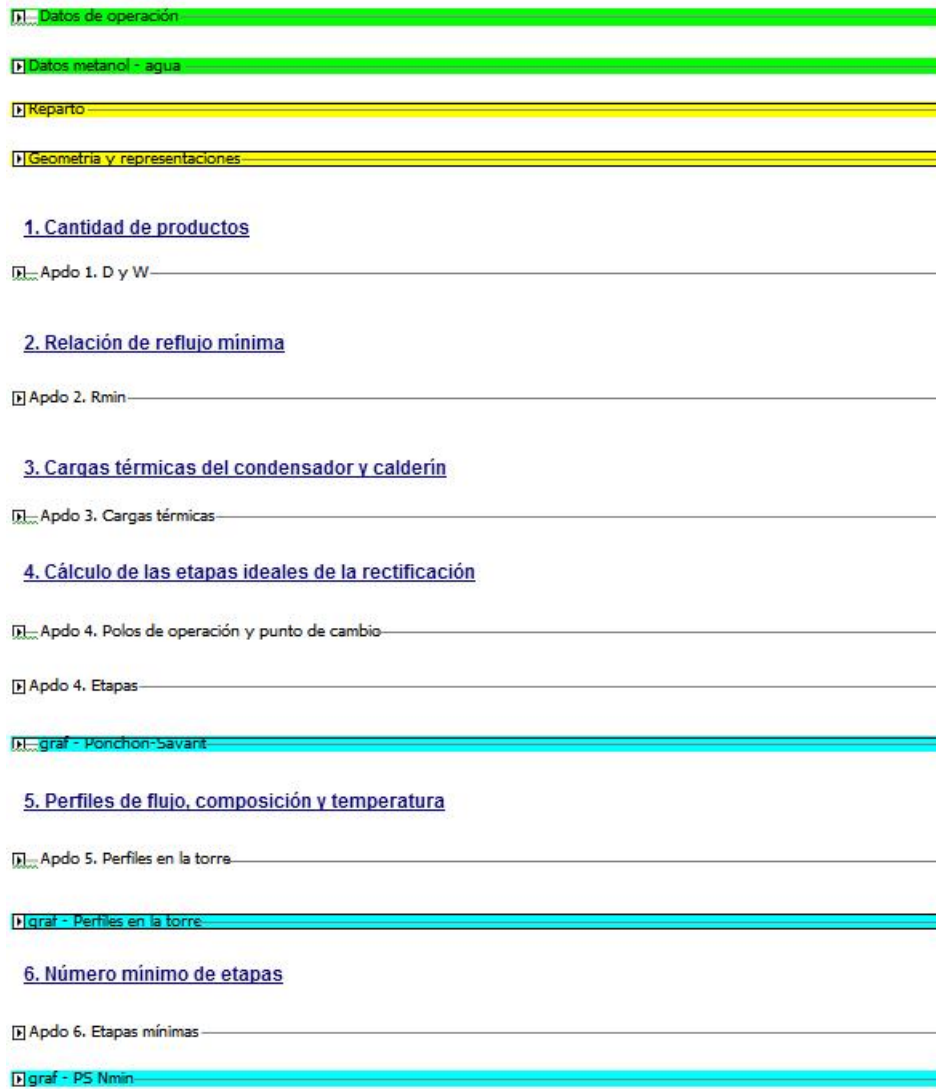
Fig. 5. Esquema del proceso de cálculo realizado para calcular un proceso de rectificación mediante el método de Ponchon-Savarit.
