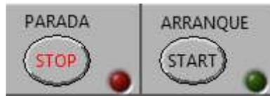
*Figura 35. Pulsadores controladores del arranque y la parada con sus respectivos leds*
