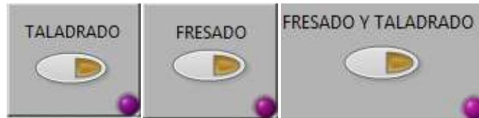
*Figura 38. Pulsadores controladores del modo de funcionamiento*
