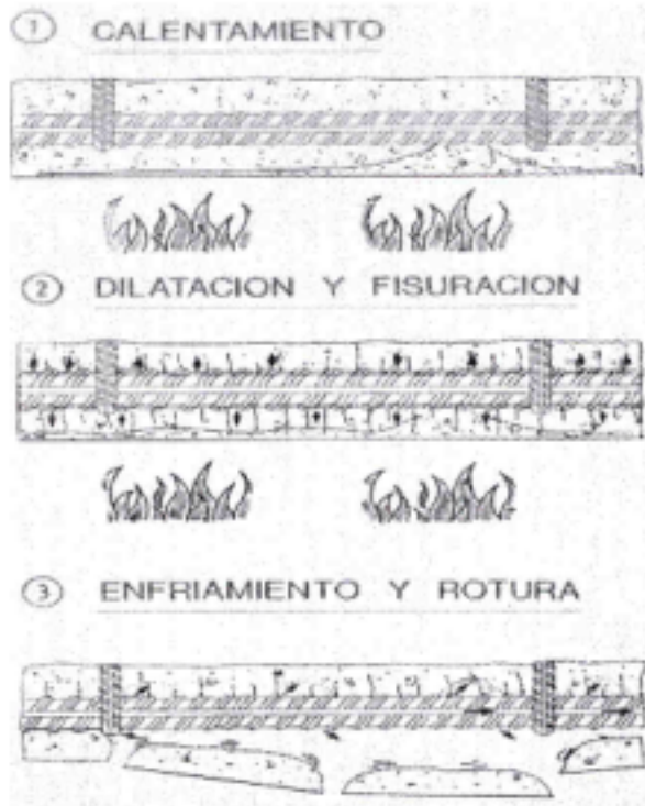
Figura 15 Esquema del proceso de pérdida de adherencia [5]
