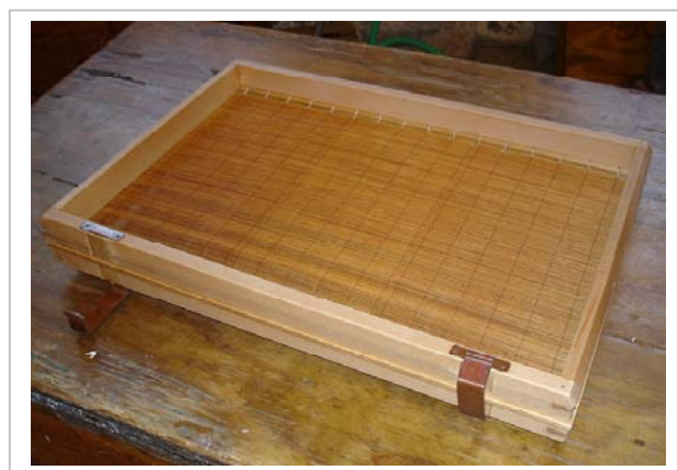
Fig. 128 Suketa : esterilla más bastidor o marco.
