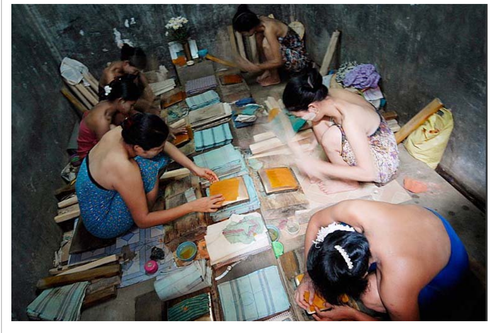
Fig. 48 Jóvenes birmanas satinando el papel de bambú golpeándolo rítmicamente con palos de madera para elaborar pan de oro.
