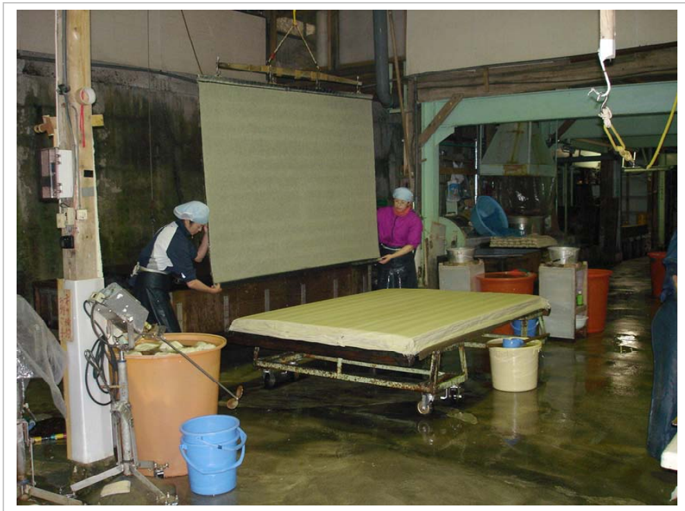
Fig. 86 Transferencia de papel de gran formato, ayudado por poleas y cadenas. Taller de Heizaburo Iwano.
