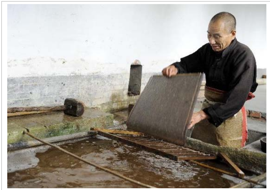
Fig. 67 Maestro paplero de Saanxi, retirando la esterilla de la hoja recién formada con la técnica de pulpa recogida.
