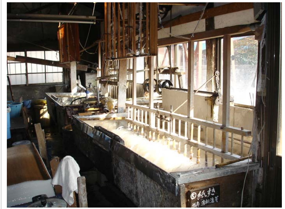
Fig. 82 Mazè o peineta agitando la pulpa de manera mecánica a través de poleas. Taller de Akira Kubo Taro.
