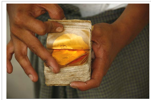
Fig. 49 Pan de oro entre papeles de bambú golpeado por 6 horas en total, listo para ser cortado y vendido en paquetes de 100 láminas.
