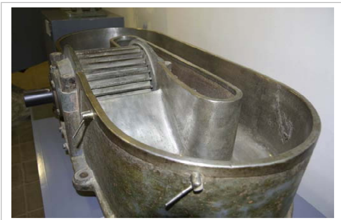
Fig. 45 Pila Holandesa y su mecanismo.
