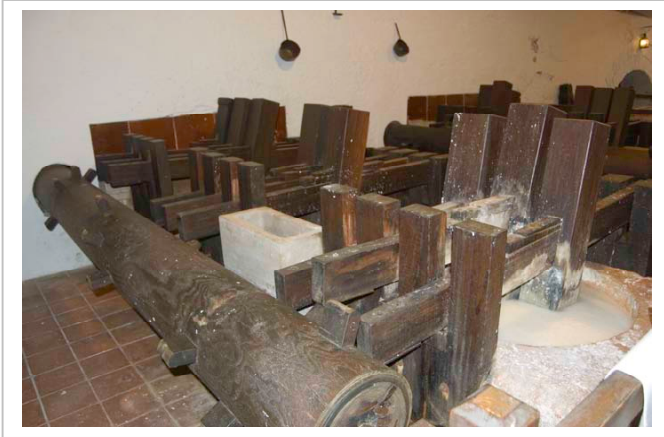
Fig. 44 Mazos de apaleo y su mecánica.
