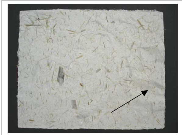
a. Secado irregular que produce bordes ondulados.
