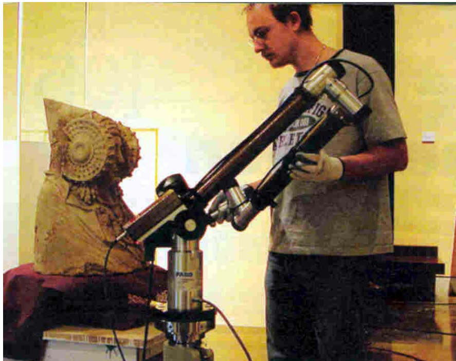
Proceso de escaneado de la Dama de Elche con el escáner Modelmaker W. Gráfico 135
