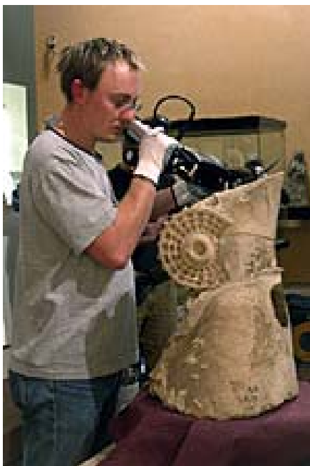
Proceso de escaneado de la Dama de Elche con el escáner 3d seti .
