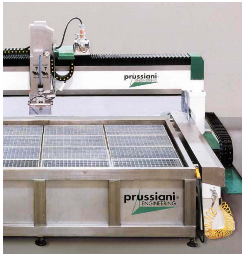
Cabezal de máquina de chorro de agua a presión.
