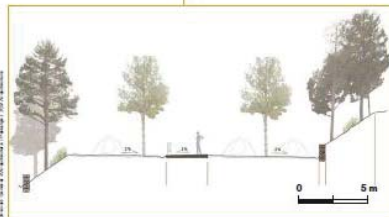
Detall de la formació d'una terrassa. D'esquerra a dreta, s'observa un marge amb les noves plantacions, les parcel·les d'acampada disposades a costat i costat del camí, l'arbrat que acompanya la zona d'acampada i, finalment, el marge següent. El control de l'escorrença superficial i la contenció de terres requereixen modificar el perfil del terreny i la incorporació de diferents elements constructius: cunetes, muretes, etc.
