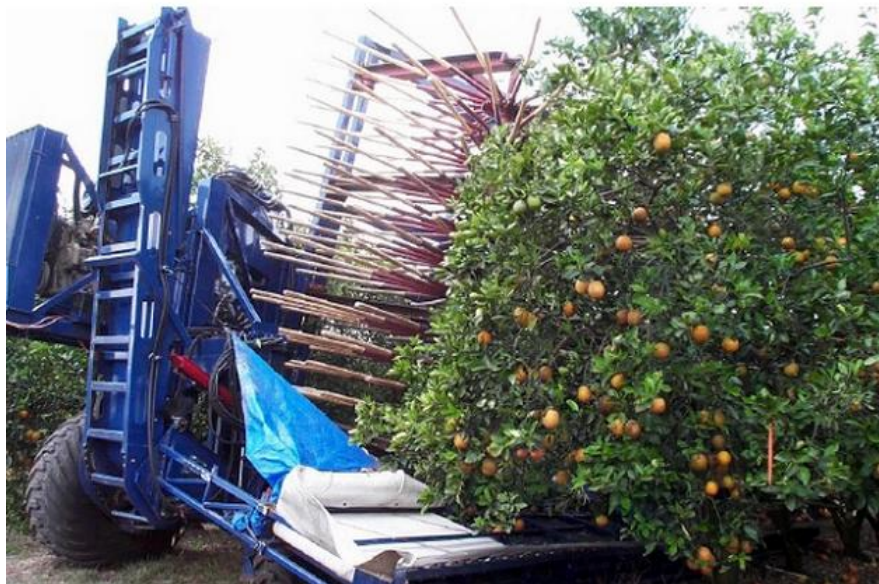
Ilustración 41: Máquina para la recolección mecanizada de las naranjas
