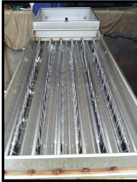
Fig. 21: Los peces van por los rodillos y van cayendo según su tamaño
