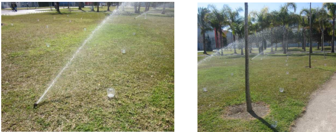
Figura 8. Riego durante los ensayos con detalle de aspersores y pluviómetros
