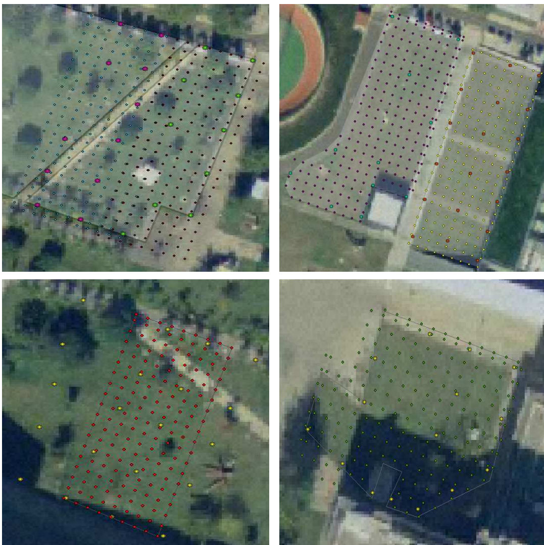
Figura 7. De izquierda a derecha y de arriba a abajo, disposición de los vasos pluviométricos y aspersores de las parcelas V.J6.0.011, V.J8.0.027, V.J8.A.001, V.J6.0.009, V.J6.0.038
