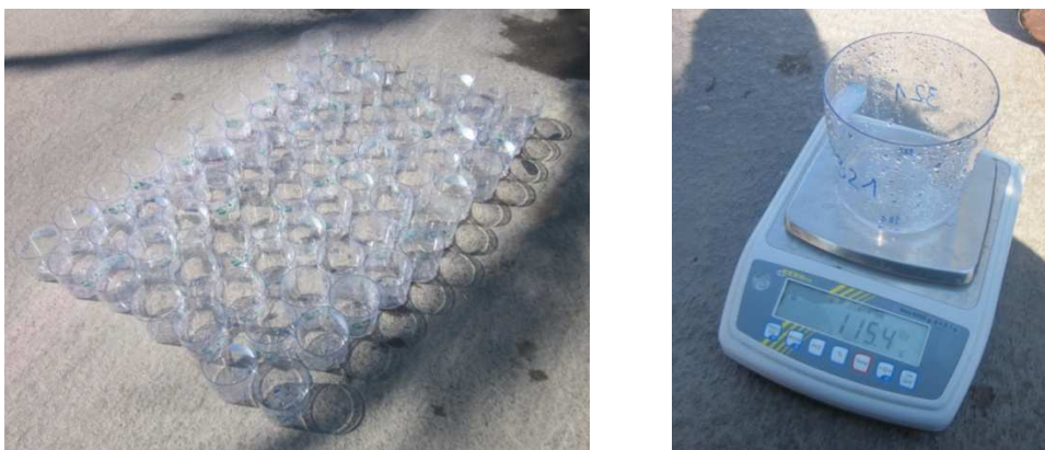
Figura 9. Izquierda, disposición de recipientes previa medida. Derecha, pesado tras el riego
