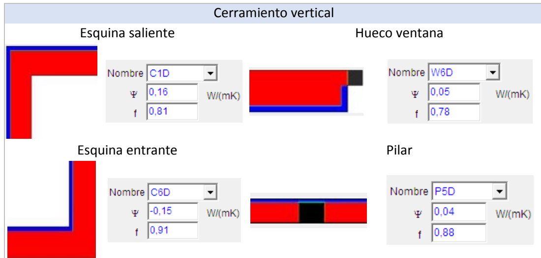
Figura 2: Puentes térmicos aislamiento exterior, Calener VYP [4]
