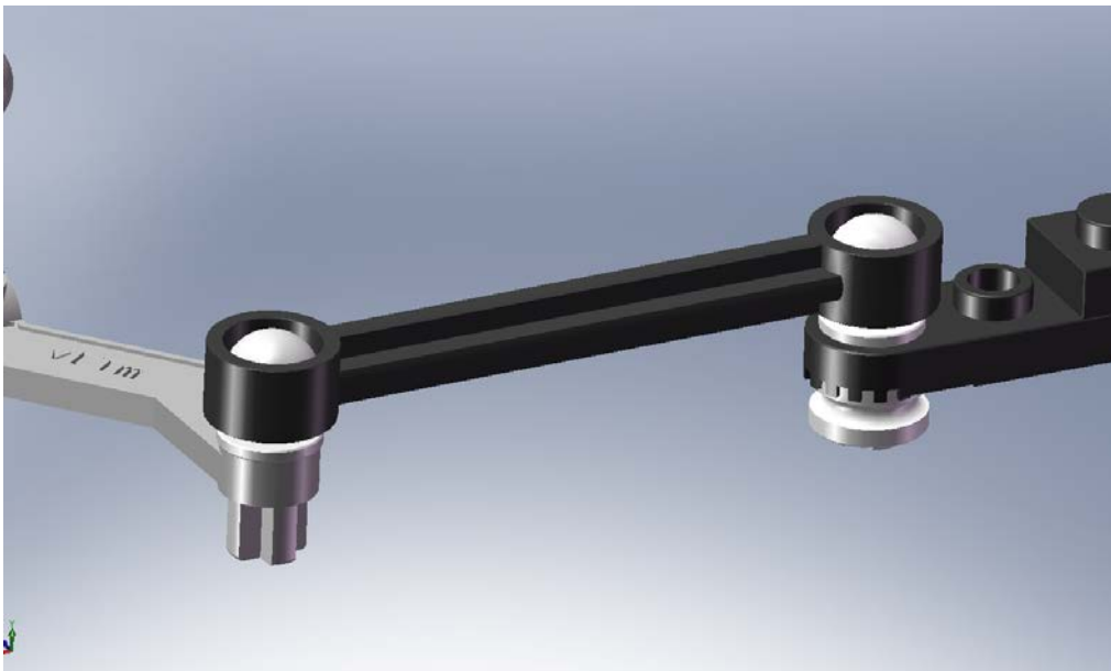
Figura 31-Componente cuyo tipo de uniones conllevará un grado de libertad parásito.
