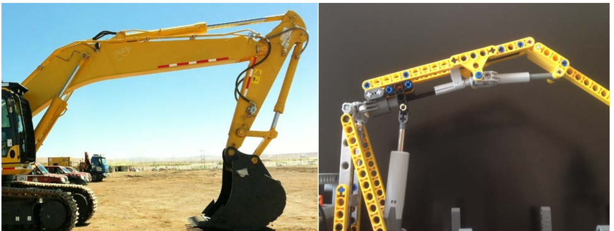
Figura 5-Comparación entre cilindros neumáticos reales y cilindros Lego© Technic 4
