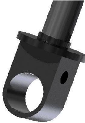
**Figura 34. Ensamblaje entre el Eje y la Cabeza inferior**
