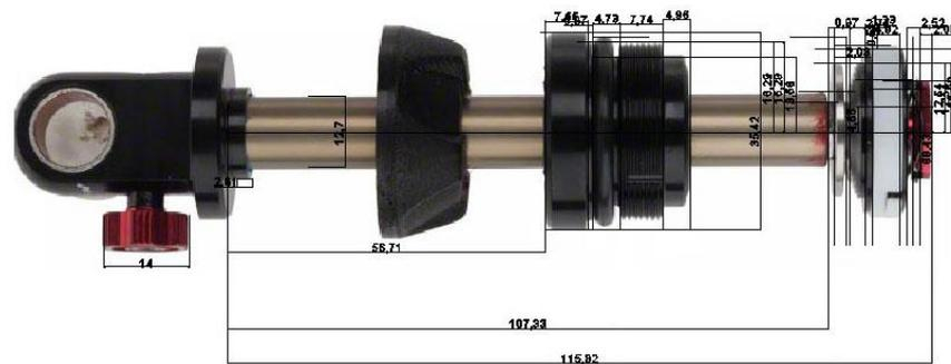
Figura 6. Deducción de las medidas del eje mediante Autodesk AutoCAD 2014. Fuente: RockShox
