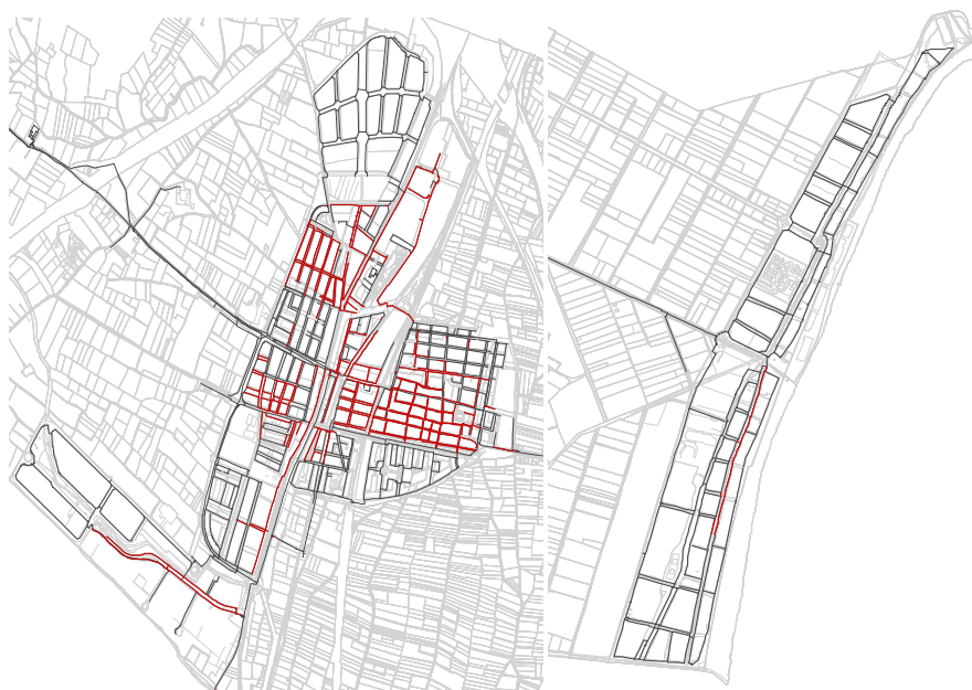
Figura 58: conducciones de FC y PVC a renovar en el casco urbano y playa (en rojo)
