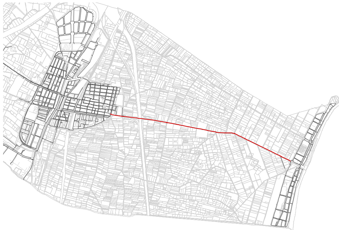
Figura 63: tubería de FC 200 de suministro a la playa.
