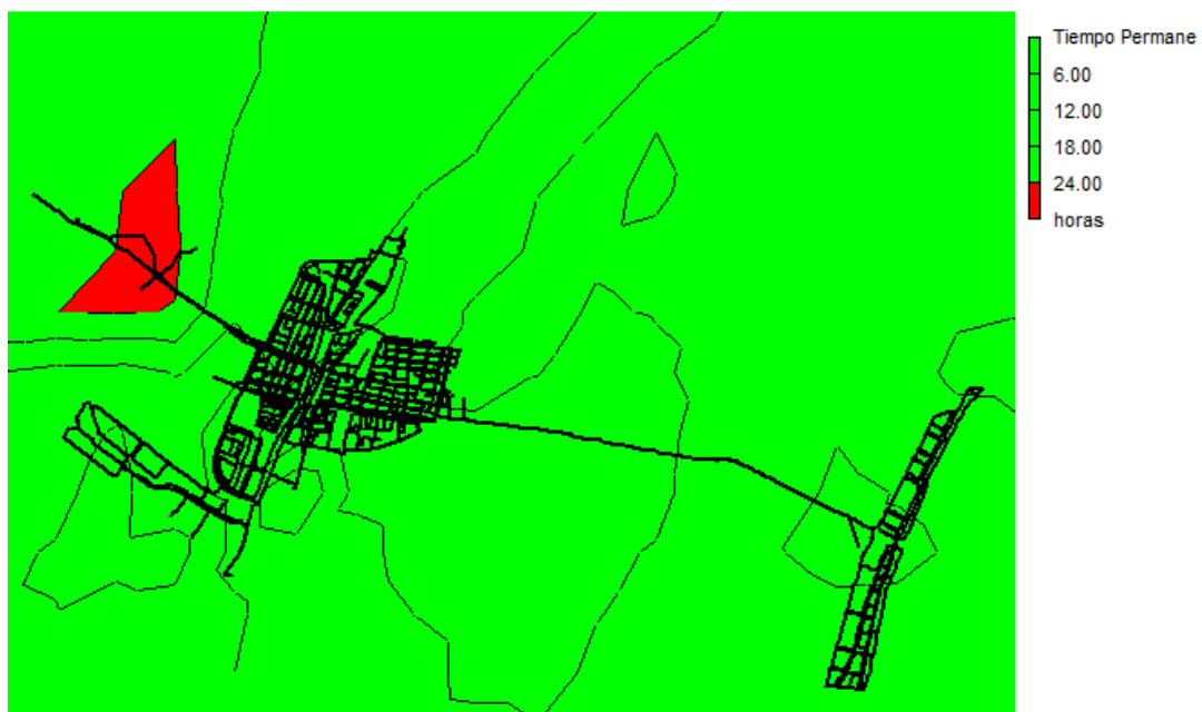
Figura 49: mapa de isolíneas de tiempo de permanencia máximo del agua en la red.
