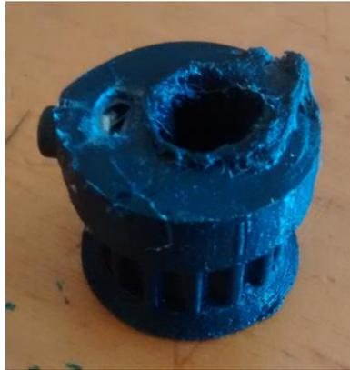
*Figura 3.3 Polea de PLA derretida por uso a alta temperatura. Fotografía del autor*
