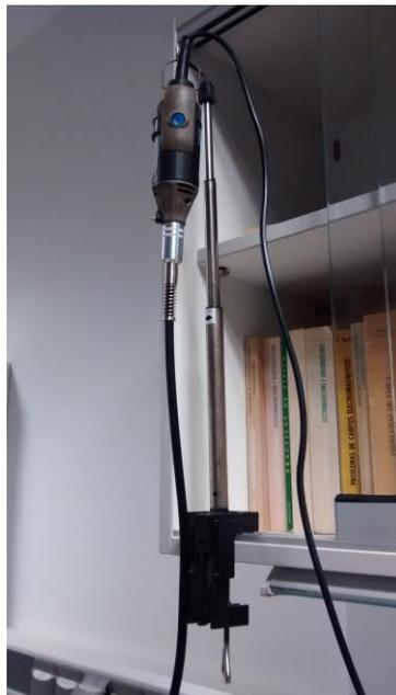
Figura 2.6 Eje flexible junto la Dremel instalados. Fotografía del autor
