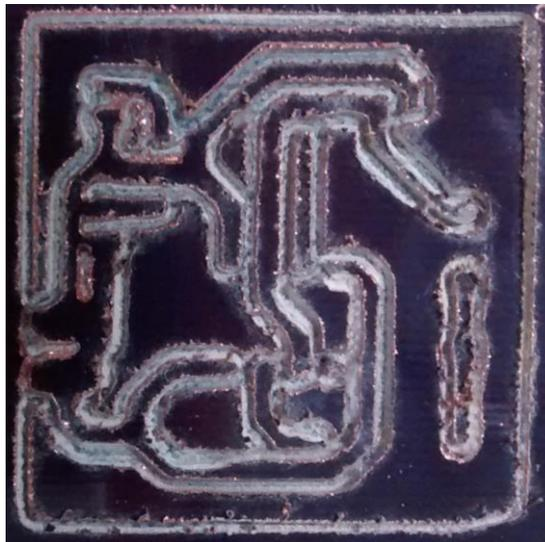
*Figura 5.18 Resultado del fresado de la placa. Fotografía del autor*
