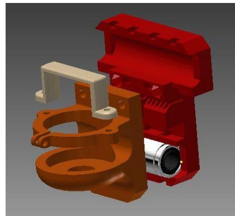
Figura 4.5 Ensamblaje del cabezal con el carro para la Prusa i3 Libelium
