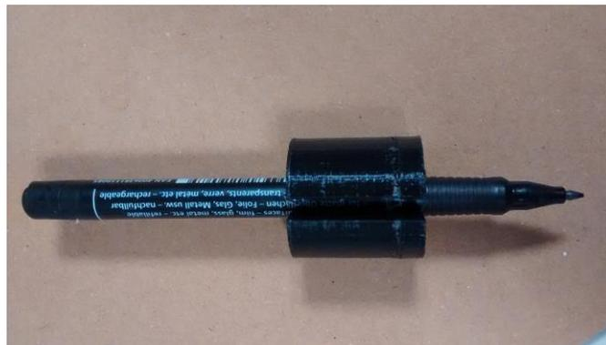
*Figura 4.20 Adaptador para un rotulador indeleble*
