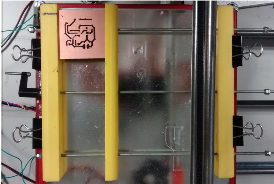
Figura 5.14 Montaje completo del soporte de placas. Fotografía del autor
