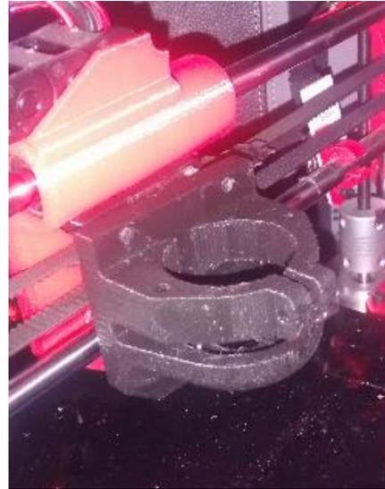
*Figura 4.10 Montaje del soporte para la impresora Hephestos.
