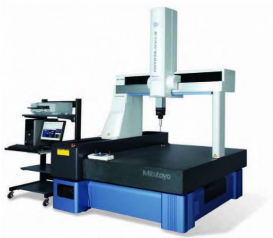
a) Máquina de medición por coordenadas.
