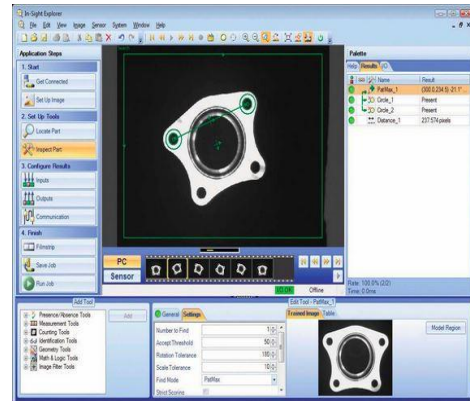
b) Medición con software "In-Sight explorer".
