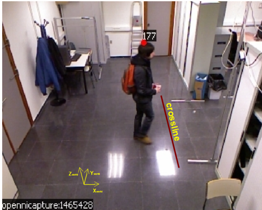
Figura 2.2: Sistema de coordenadas de nuestro sistema y línea de cruce ( crossline ) de entrada y salida del comercio.
