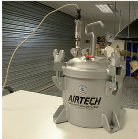
Fig. 3.13: Proceso de comprobación de la presión en el interior del recipiente presurizado
