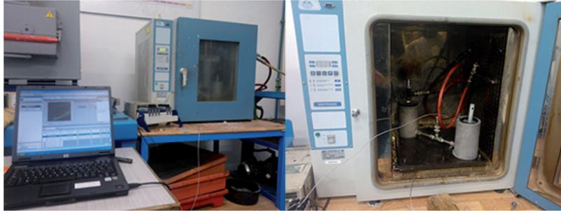
Fig. 5.12: Montaje experimental para la fabricación de composites vía VARTM
