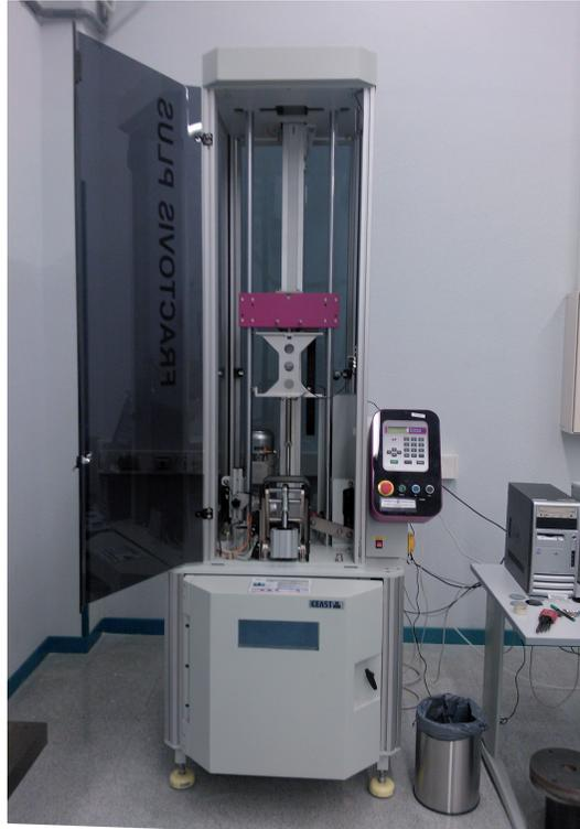
Fig. 5.16: Dispositivo de ensayo por caída de dardos instrumentados Fractovis Plus
