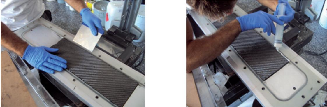
Fig. 3.17: Proceso de carga del molde: colocación y sellado
