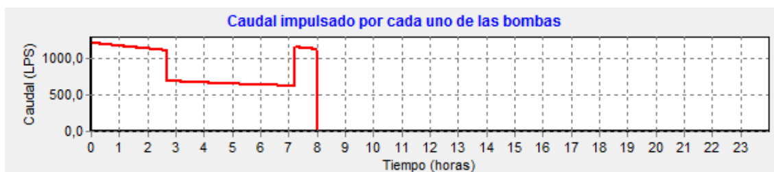
Figura 77. Caudal impulsado por cada una de las bombas
