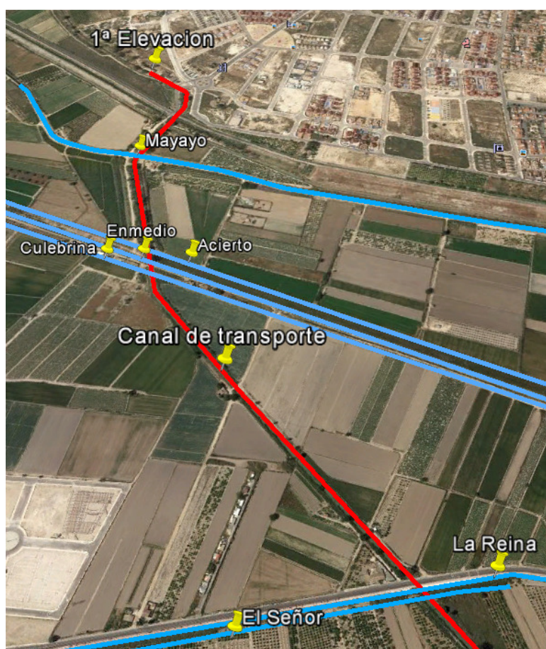
Ilustración 5. Azarbes de drenaje y canal de transporte
