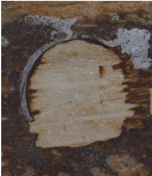
Figura 16. Detalle de una de las probetas de masilla tras la prueba de adhesión donde se ha eliminado madera.
