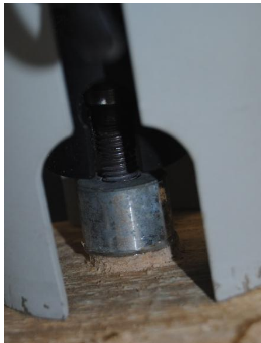
Figura 14. Detalles del proceso del ensayo de adherencia.
