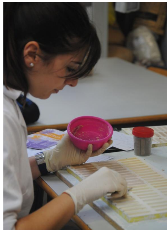
Figura 3. Aplicación de las masillas en los moldes.
