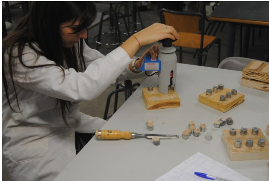
Figura 13. Ensayos de adherencia de las masillas con el medidor de adherencia electr nico KN-10
