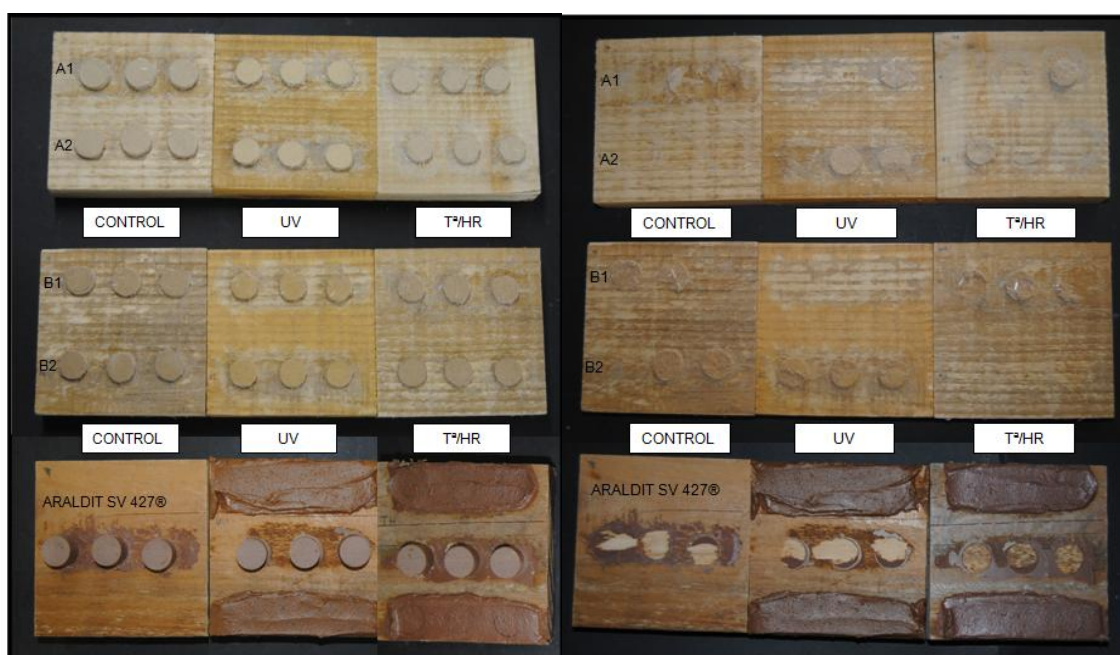
Figuras 11 y 12. Vista general de las masillas antes y después del ensayo de adhesión.
