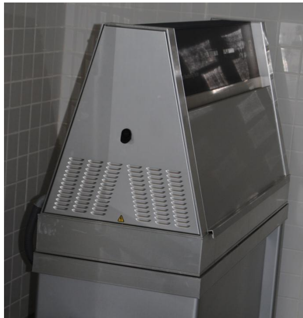
Figura 8. Cámara de envejecimiento acelerado por exposición a la radiación UV.
