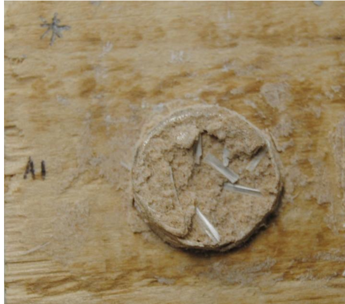
Figura 17. Detalle de una de las probetas de masilla tras la prueba de adhesión donde se han quedado restos de masilla en la superficie.
