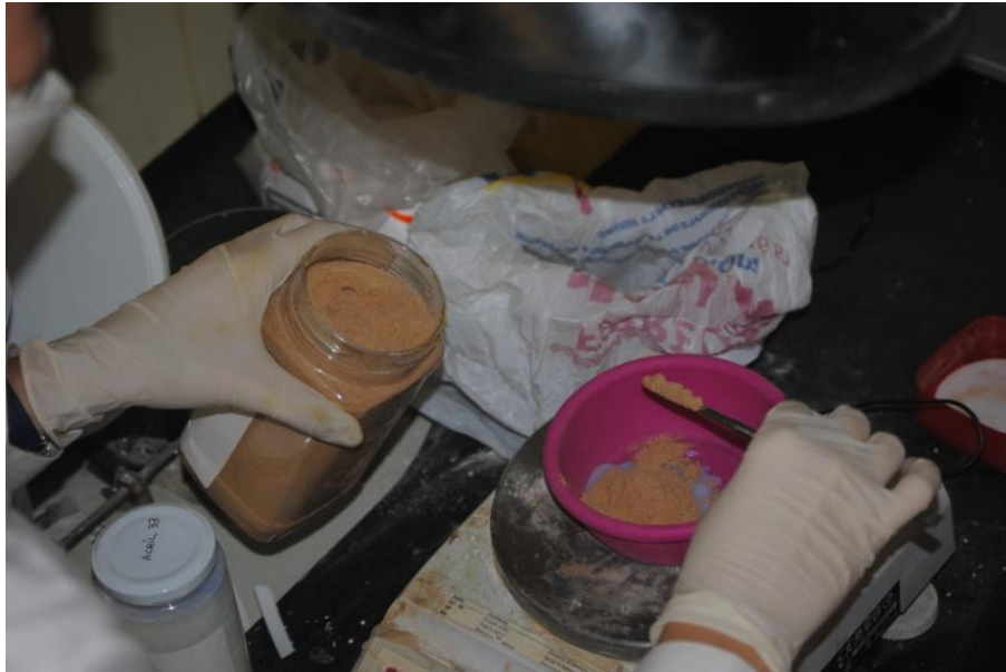
Figura 1. Pesaje de cada uno de los componentes de las masillas en una báscula digital de precisión.
