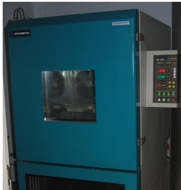
Figura 9. C mara de envejecimiento acelerado termohigrom trico.
