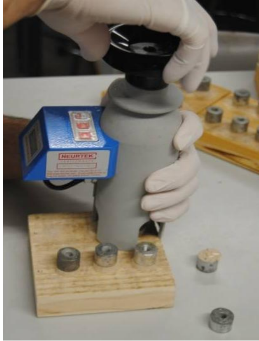
Figura 10. Medidor de Adherencia KN-10.
