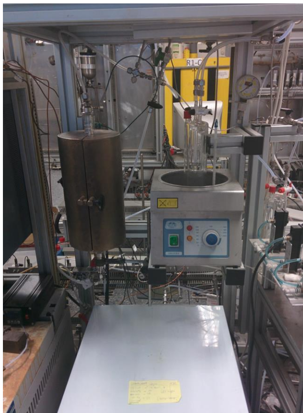
Figura 12: horno de calefacción y llaves de reactor/bypass
