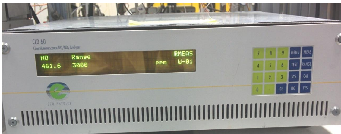
Figura 14: analizador ECO PHYSICS modelo CLD-60 por quimioluminiscencia
