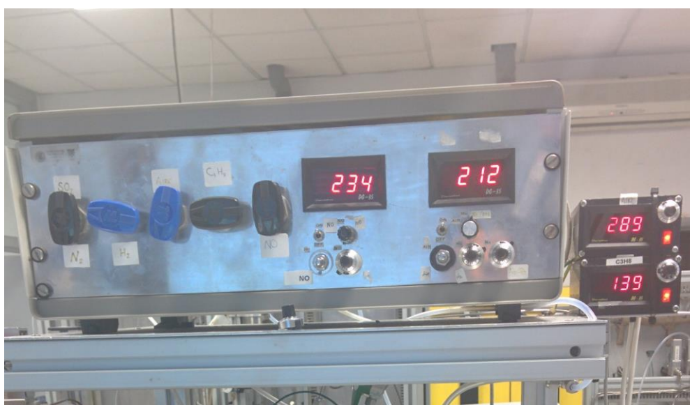
Figura 13: controladores de caudal ( \text{N}_2 , \text{NO} , \text{C}_3\text{H}_8 y aire)
