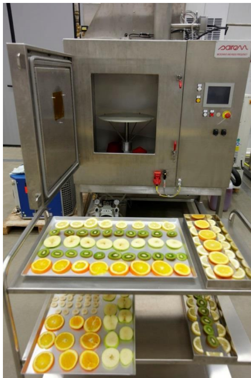
Figura 2.6: Microondas piloto utilizado para las operaciones de secado.
