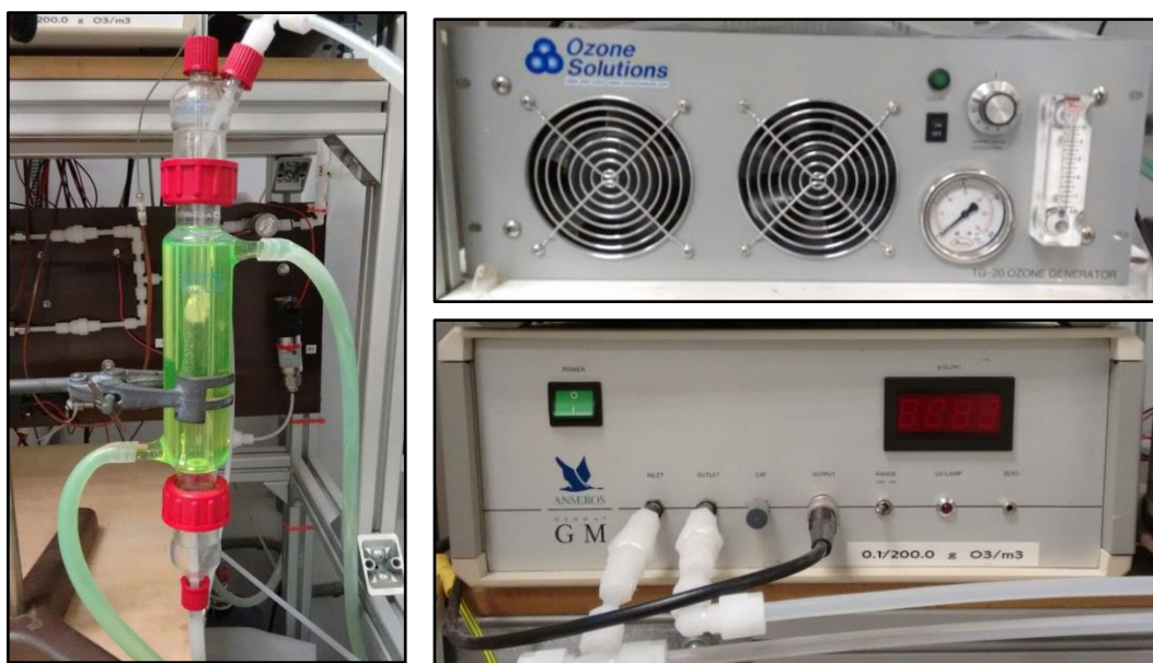
Figura 12. Sistema experimental: reactor (izq), generador de ozono (dcha, arriba) y medidor de ozono (dcha, abajo)
