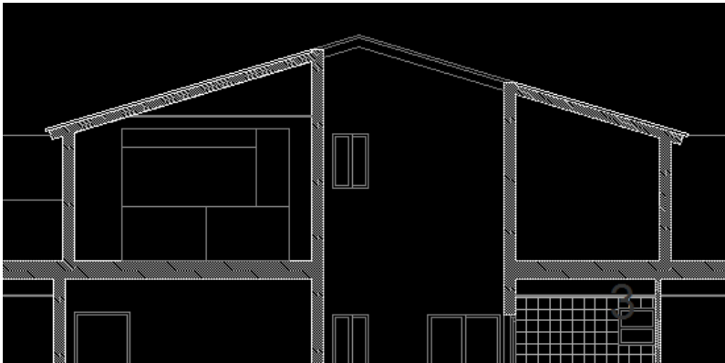
Ilustración 5. Obtenida del plano de sección del proyecto. Vemos que la cubierta es de forjado inclinado.
