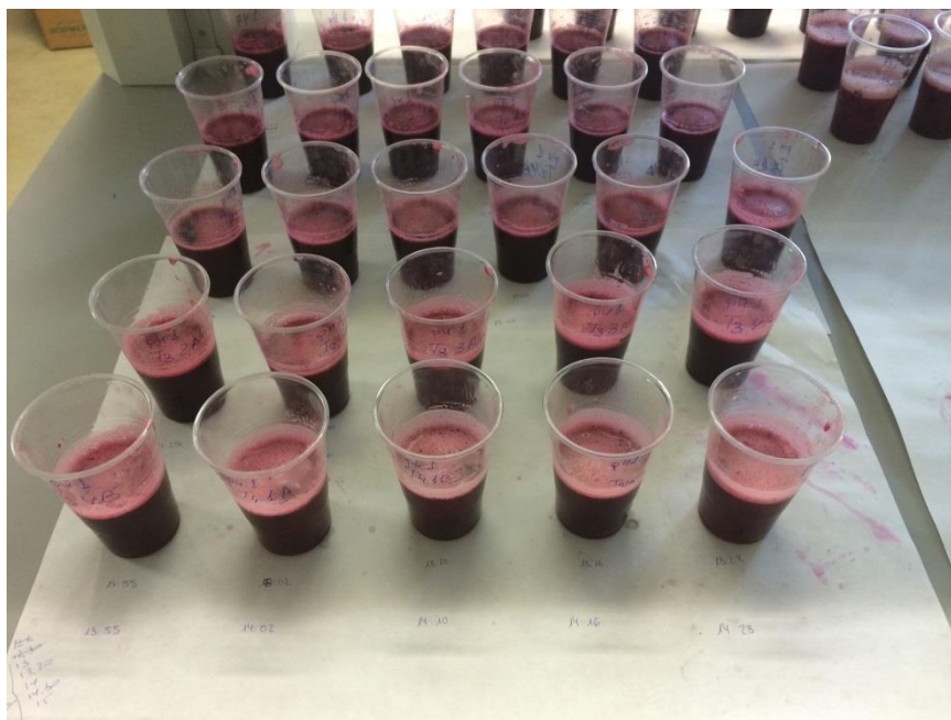
Figura 6.46. Laboratorio de la Universidad Politécnica de Valencia donde se realizó las mediciones de los parámetros de madurez, recogida de los homogeneizados tras la trituración en Termomix.
