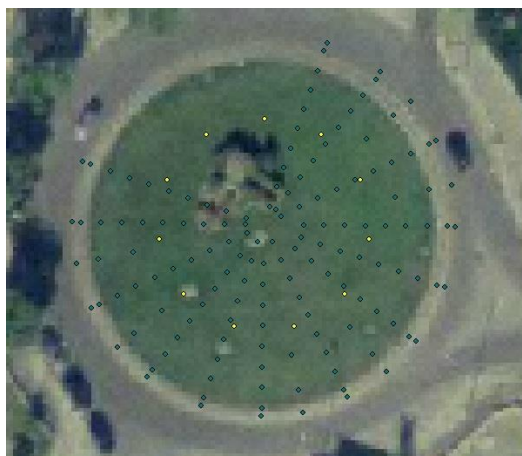
Figura 13: Distribución de pluviómetros (azul) y aspersores (amarillo) en Parcela Rotonda.
