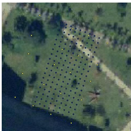
Figura 16: Distribución de pluviómetros (azul) y aspersores (amarillo) en parcela Pradera Central.
