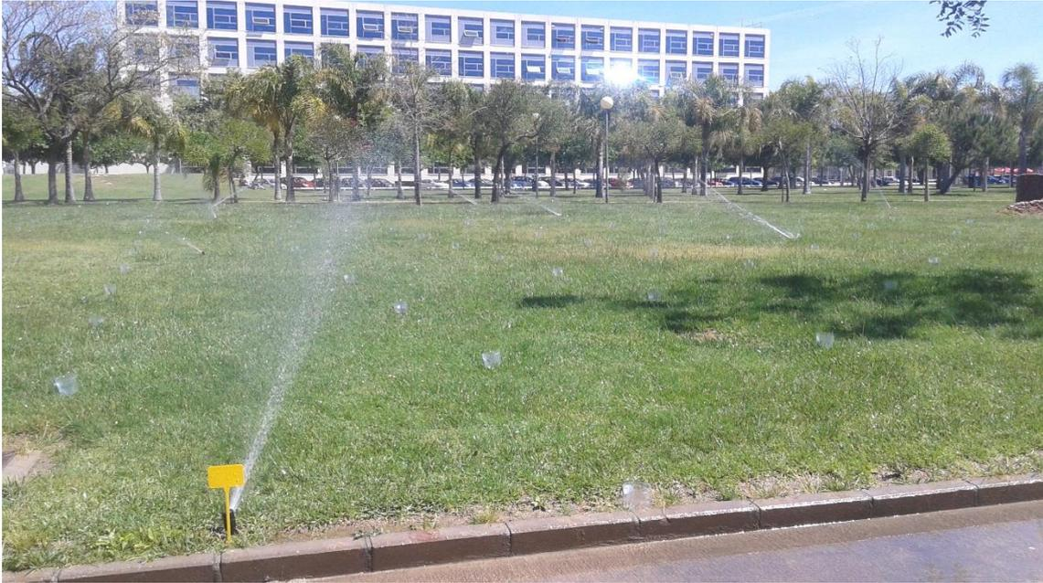
*Figura 42: Ensayo de pluviometría en parcela Pradera Central.*
