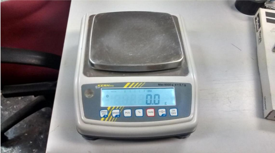
*Figura 44: Báscula utilizada para el pesaje de los pluviómetros.*
