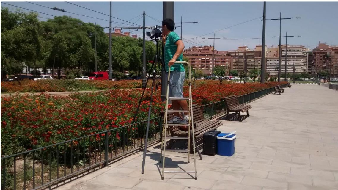
*Figura 58: Toma de imágenes térmicas en la detección de fugas.*
