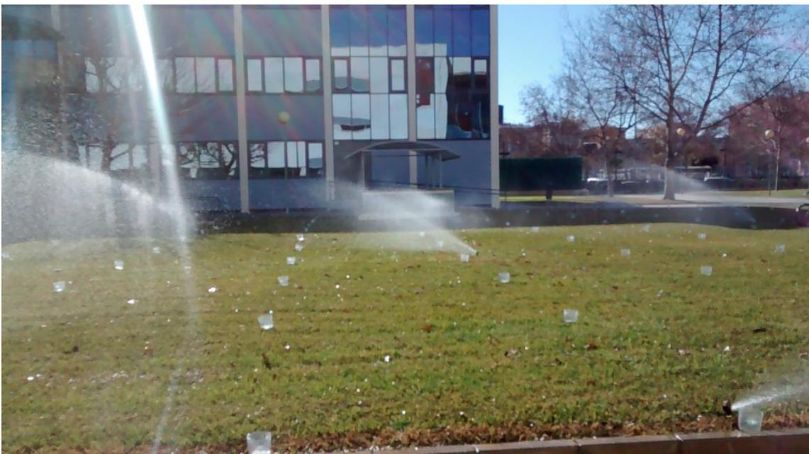
*Figura 39: Ensayo de pluviometría en parcela Nexus.*
