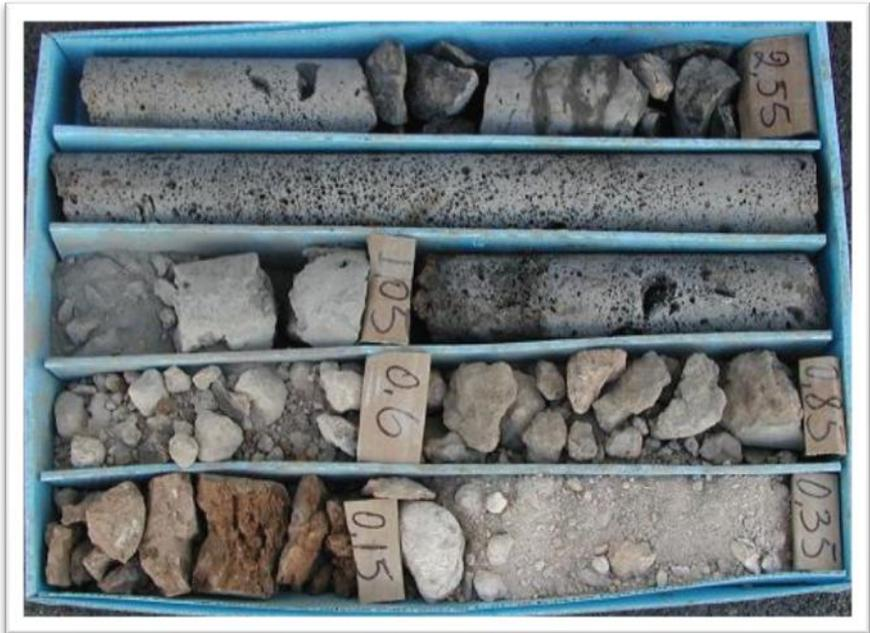
Figura 8. Verificación del tipo de terreno en caja de sondeos. Fuente: <http://www.geotecnicadeallirroz.com>
