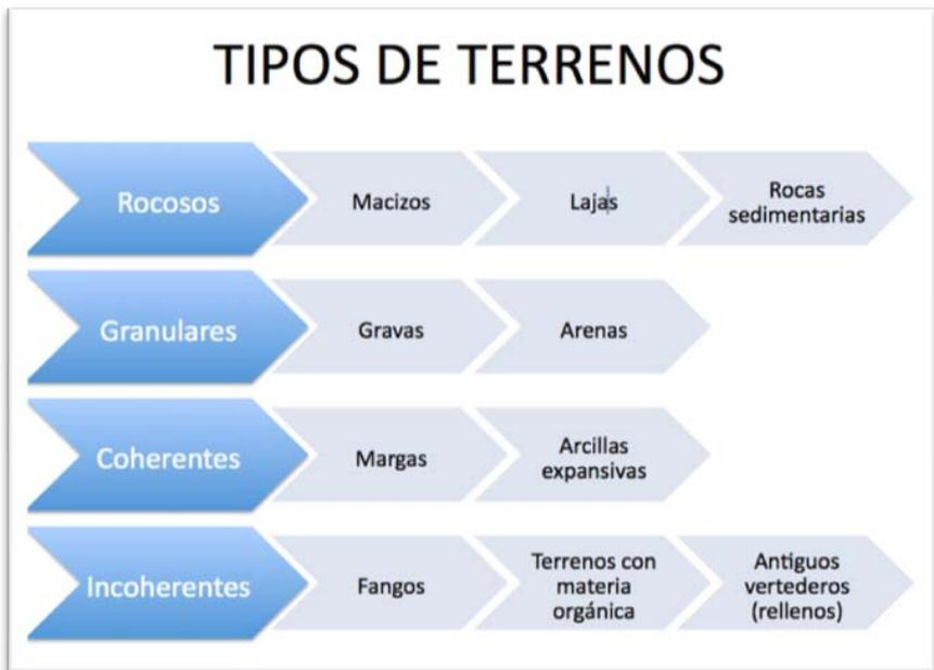
Figura 2. Esquema tipología terrenos. Fuente: elaboración propia
