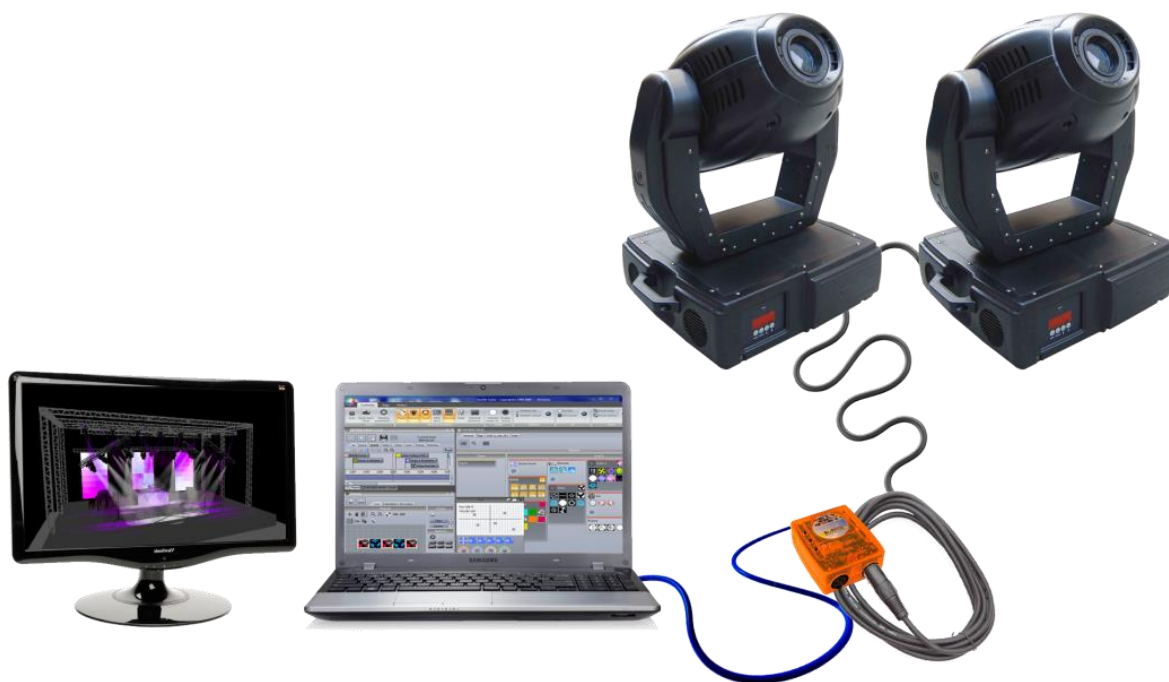
Fig. 24. Exemple de connexió per al control DMX512 amb ordinador i interfície.
