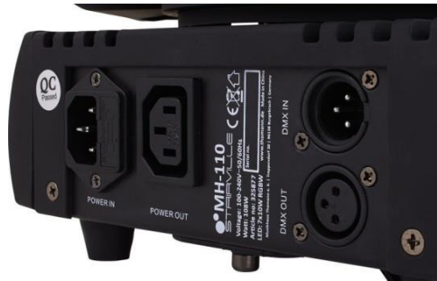
Fig. 13. Exemple de connexions en un dispositiu controlat per DMX [MH-110].
