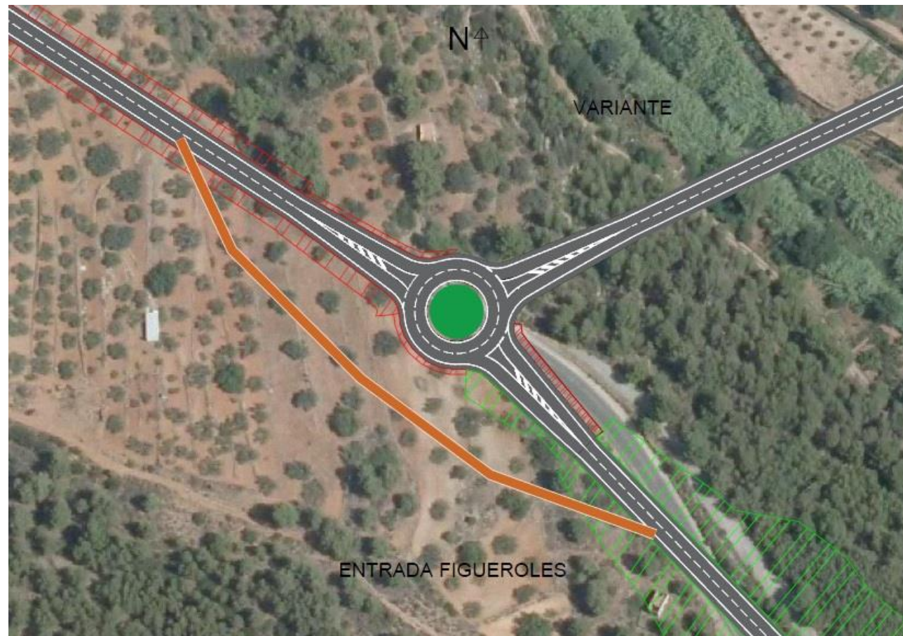
Desvío tráfico en la construcción del nudo Oeste Figura 3.13
