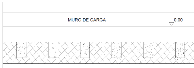
Detalle 10 Zapata corrida. Rehabilitar con acero. Fuente propia
