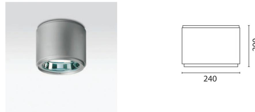
Descripción: Luminaria para aplicación de techo equipada con óptica para iluminación general, destinada al uso de lámparas fluorescentes compactas 2x26W TC-T EL, alimentadas con cableado electrónico. Placa portacomponentes en aluminio fundición a presión, reflector en aluminio superpuro, cuerpo cilíndrico en aluminio perfilado torneado, cuadro inferior en policarbonato de alta resistencia.
