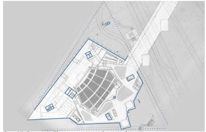
Img. 27: Sótano -2. Elementos estructurales verticales.
